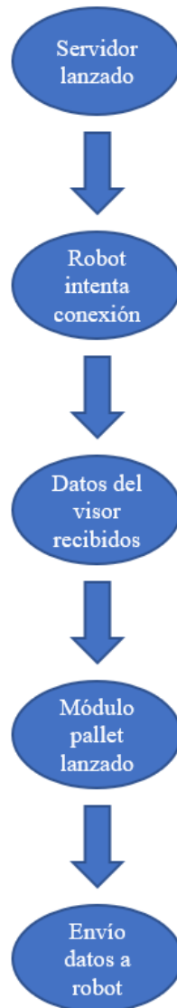
Figura 3.12 Funcionamiento del servidor
