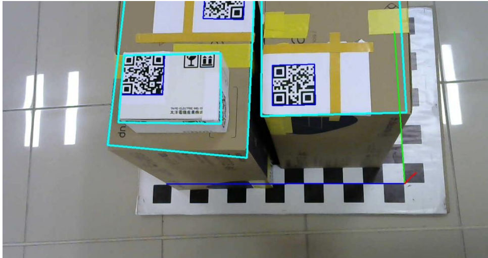
Figura 4.4 Detección de los QR con la orientación
