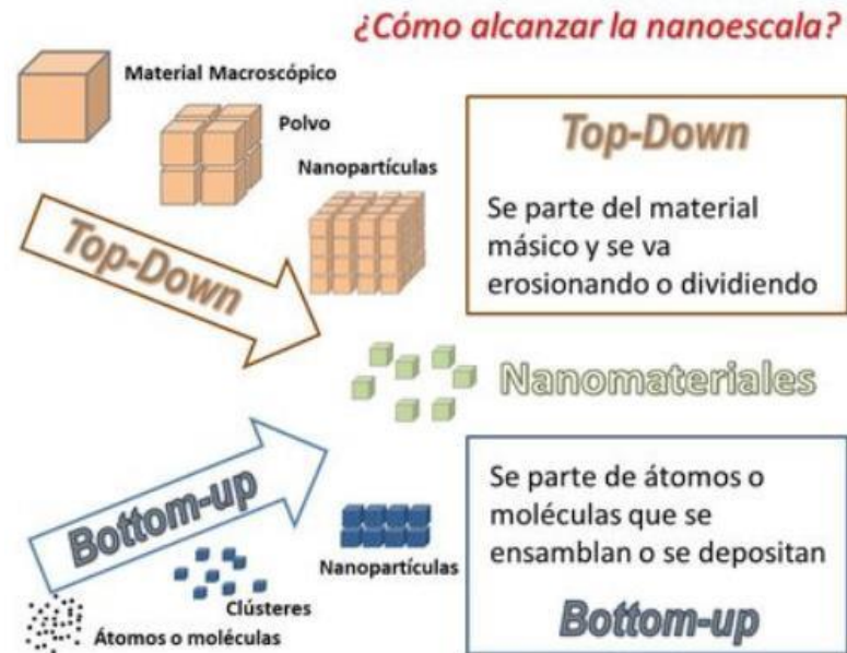
Fig. 3. Esquema explicativo de los procesos "de arriba hacia abajo" y "de abajo hacia arriba" para la obtención de NPAs
