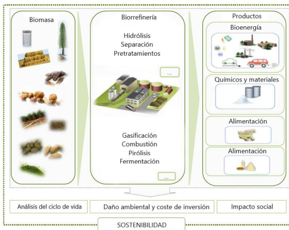
Figura 2. Esquema del concepto de biorrefinería (Ferreira, 2007).
