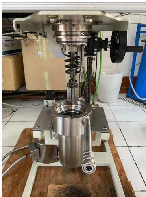
Figura 7. Dispositivo experimental de Autoclave Engineers .
