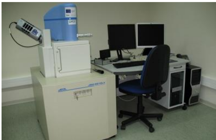
Figura 8. Microscopio electrónico de barrido JEOL 6610LV disponible en los Servicios Científico Técnicos de la Universidad de Oviedo.
