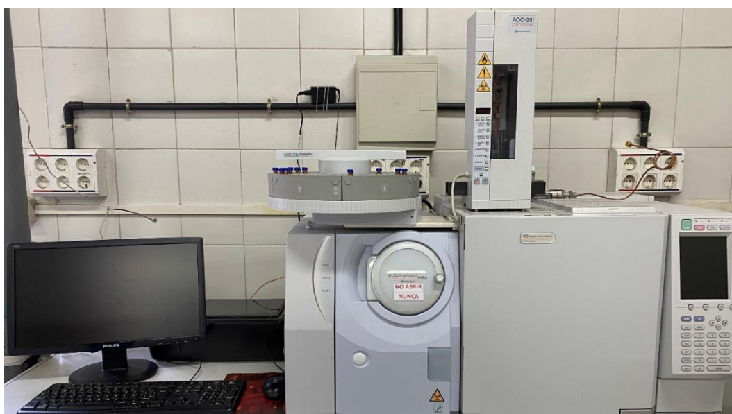
Figura 10. Cromatógrafo GC-Masas empleado para el análisis cualitativo.
