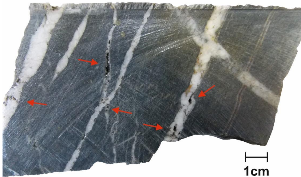
Figura 23. Muestra macroscópica P3 154 B en la que se aprecia a una familia de venas paralelas a la foliación principal de la roca encajante (meta-arenita), además de una vena oblicua a la foliación principal que se deforma ligeramente cuando cruza a otras venas. Las flechas rojas indican cavidades, certificando un relleno incompleto de algunas venas paralelas a la foliación principal.
