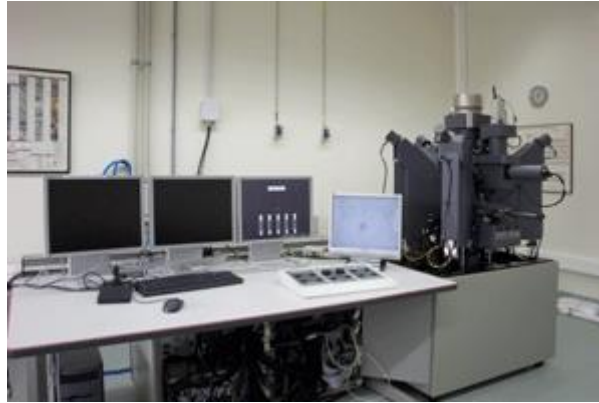
Figura 7. Equipo de Microsonda Electrónica de los Servicios Científico-Técnicos de la Universidad de Oviedo.
