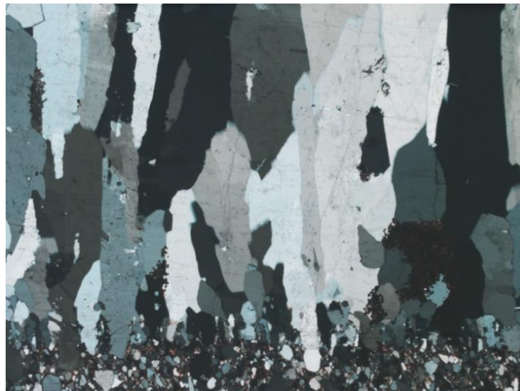
Figura 14. Ejemplo de textura “elongated blocky” en una vena de cuarzo. Todos los cristales tienen la misma dirección, partiendo desde la roca encajante (arenisca), hacia el centro de la vena (parte superior de la foto). Fuente: Bons, 2000.
