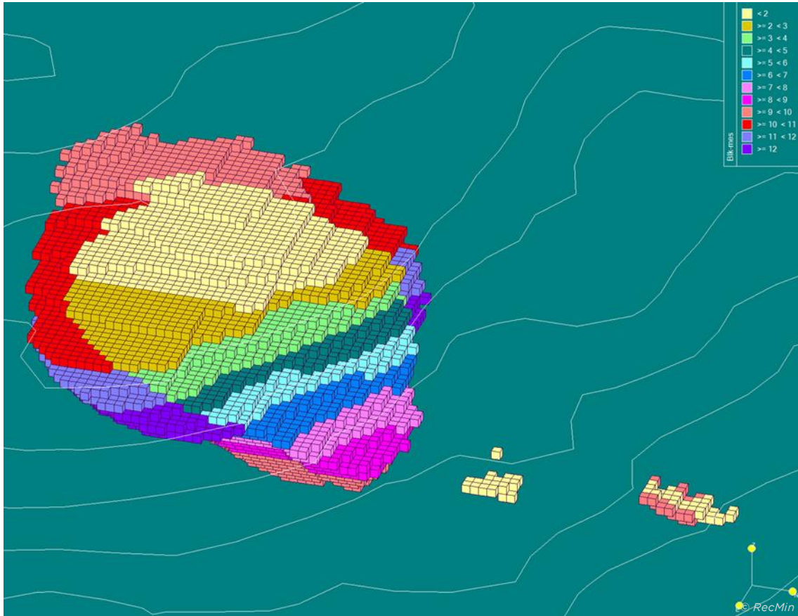
Figura 104. Planificación mes a mes del primer año de explotación en módulo "Dibujo" de RecMin
