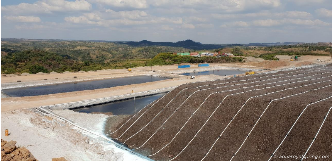
Figura 25. Proceso de lixiviación mediante pilas dinámicas (on/off)
