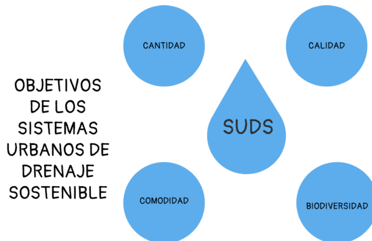
Ilustración 29. Factores clave en el diseño de SUDS.
