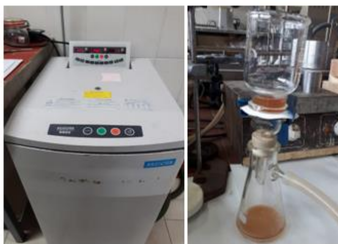
Figura 15. A) Centrífuga utilizada para el pretratamiento B) Filtración por quitasatos o por bomba de vacío
