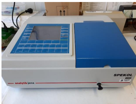
Figura 29. Espectrofotómetro utilizado para la determinación del índice colorimétrico.
