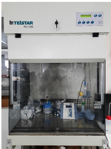
Figura 17. Campana de flujo laminar empleada para el crecimiento del hongo y el ensayo
