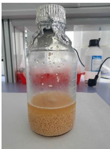
Figura 18. Conservación de los pellets de P. chrysosporium en la disolución NaCl 0,8%, en nevera a 4°C.
