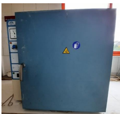
Figura 30. Estufa utilizada para realizar peso seco de la muestra
