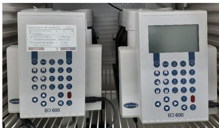
Figura 25. Equipos de medida para el análisis de DBO 5 de las muestras, en el interior de un incubador que mantiene la temperatura a 20°C.
