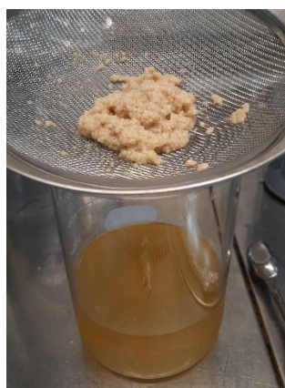
Figura 19. Recogida de los pellets de P. chrysosporium de la disolución de NaCl al 0,8% para ser pesado y adicionar la cantidad exacta a cada matraz.
