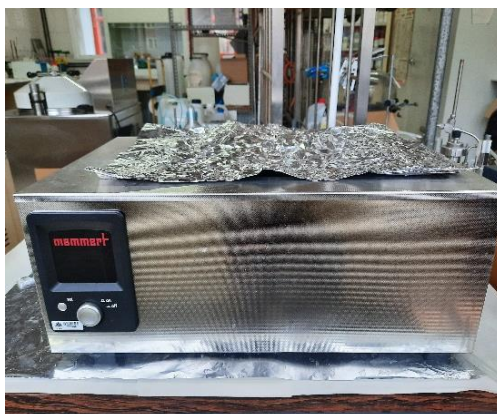
Figura 27. Baño utilizado, el cual se mantenía a 22°C.
