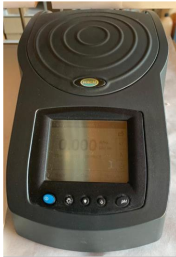
Figura 25. Espectrofotómetro utilizado para la determinación de la DQO.
