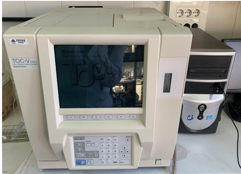
Figura 27. Equipo utilizado para la cuantificación del TOC.
