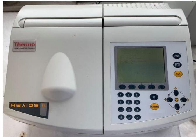
Figura 22. Espectrofotómetro utilizado en los análisis de color.
