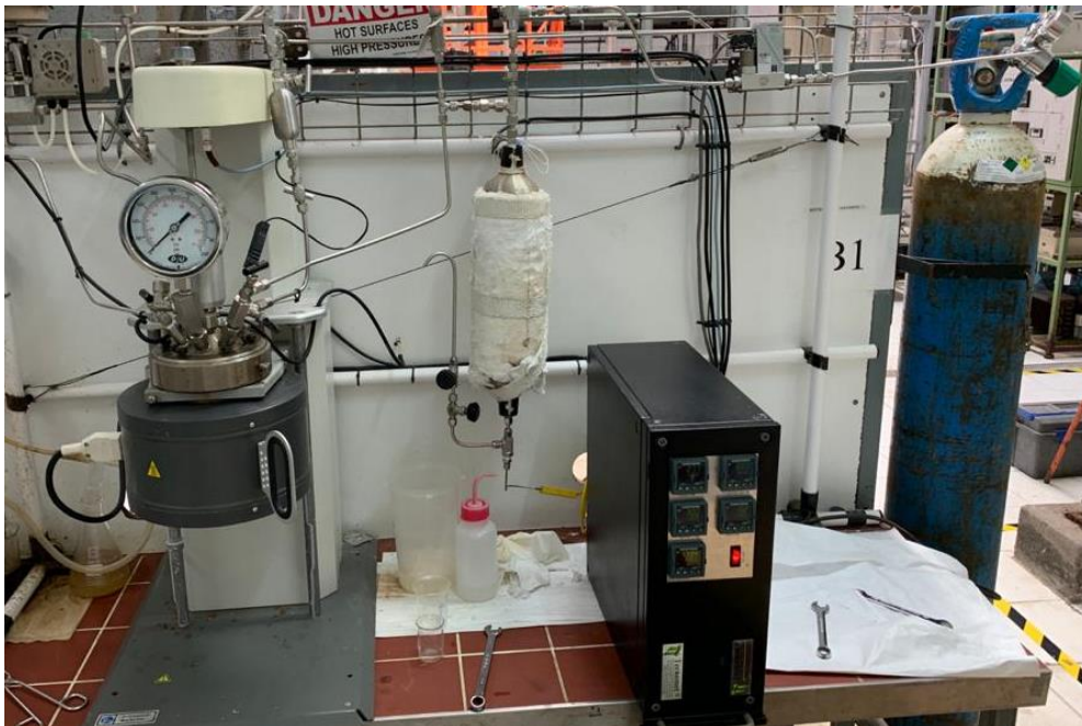
Figura 19. Reactor empleado en la oxidación de los lodos biológicos.
