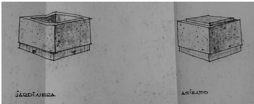
Figura 70. Jardineras y asientos de hormigón
