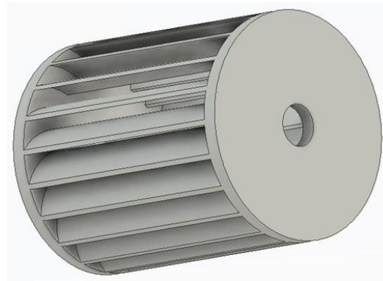
Figura 5. Diseño 3D del rodete con ambas placas laterales.
