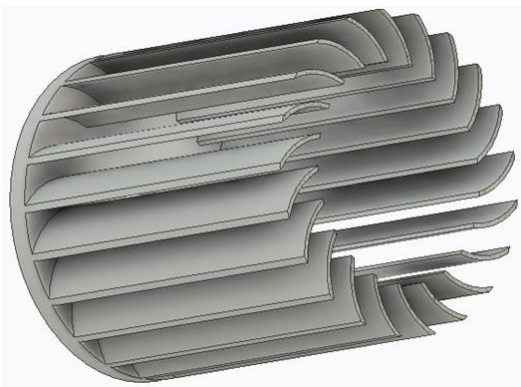
Figura 4. Diseño 3D del rodete sin una placa lateral.
