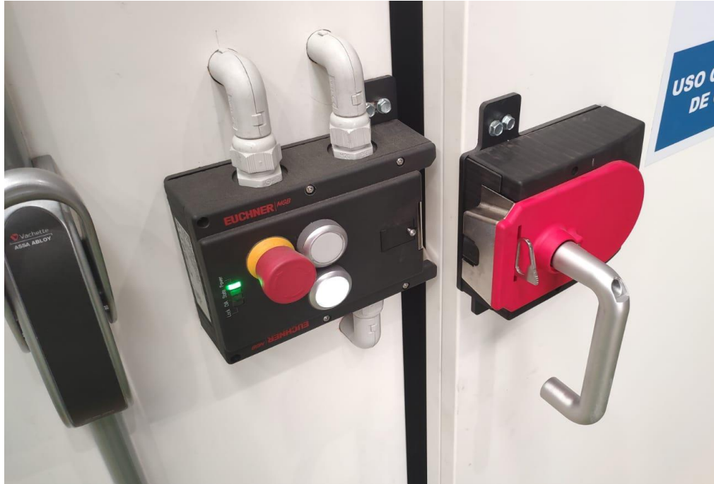
Figura 5. 6 Cierre de seguridad con pestaña para candado
