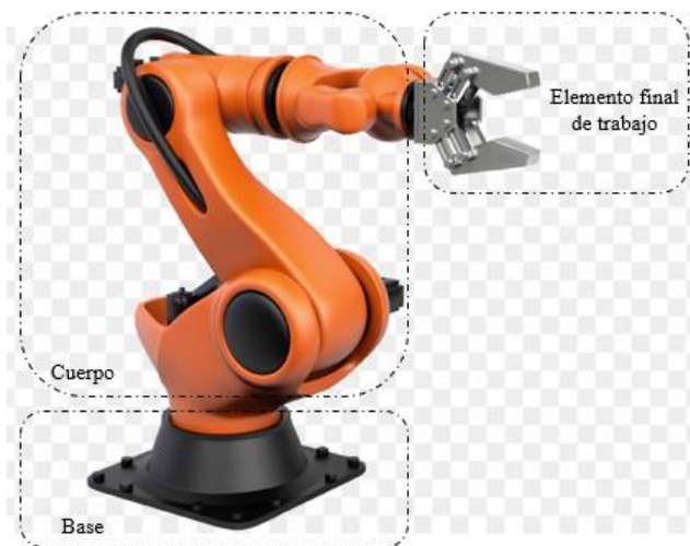
Figura 1. 3 Partes de un robot industrial [7]
