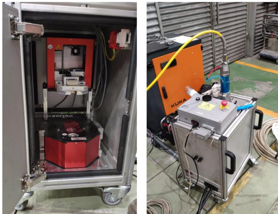
Figura 5. 18 Cabina portátil (propiedad del proveedor) para protocolo de aceptación
