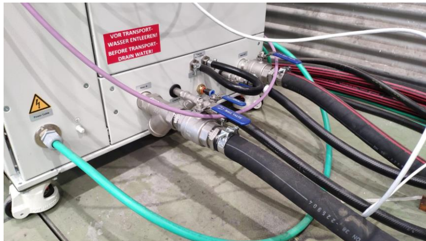
Figura 5. 17 Conexiones de refrigeración del láser
