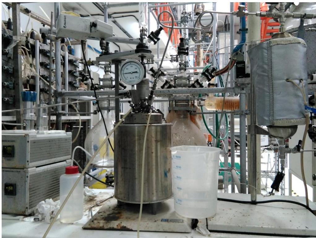
**Figura 9. Reactor PARR empleado para la OH y HT de lodos.**
