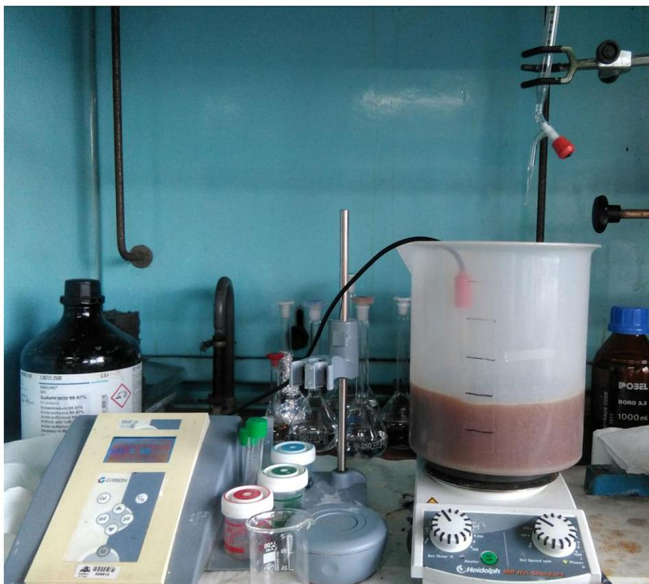
**Figura 8. Montaje para el proceso de deslignificado del licor negro.**
