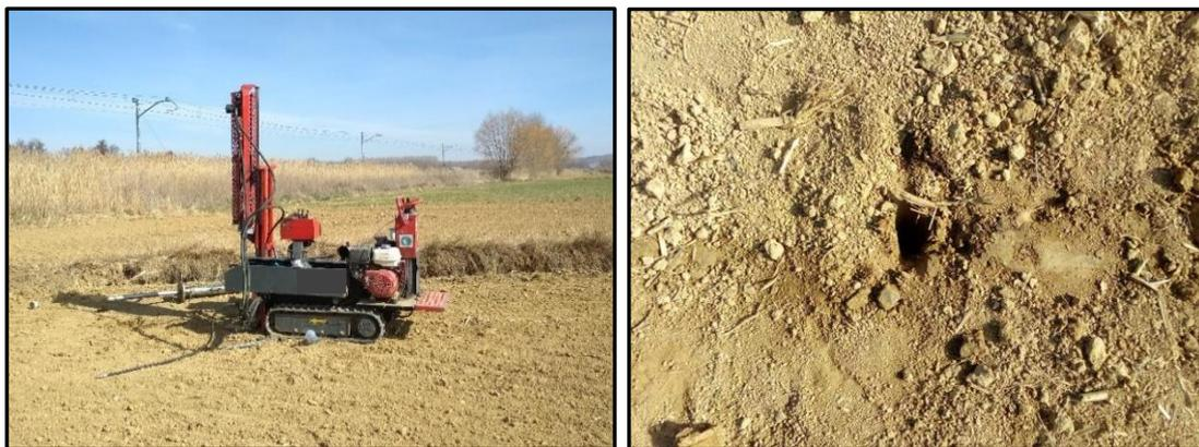
*Figura 2.4 En la imagen de la izquierda se observa un penetrómetro dinámico (DPSH). A la derecha se muestra el tipo y tamaño de perforación de este tipo de prospecciones.*
