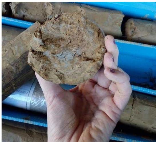
Figura 3.14 En la imagen se muestra un nivel con nódulos arcillosos grises.
