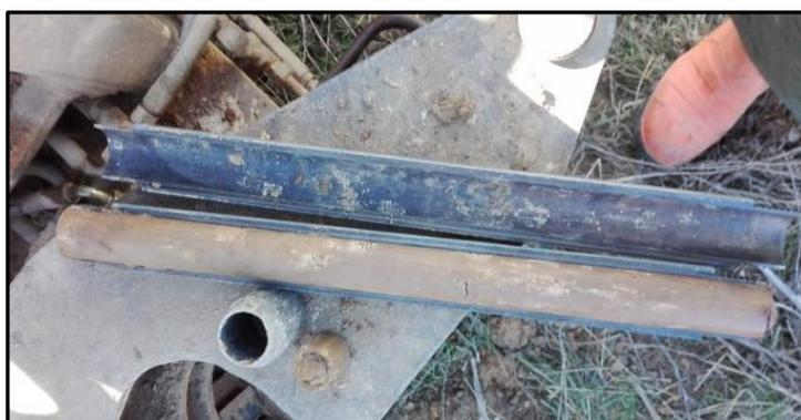
Figura 2.5 En la imagen se observa un tomamuestras tras la realización de un ensayo SPT.
