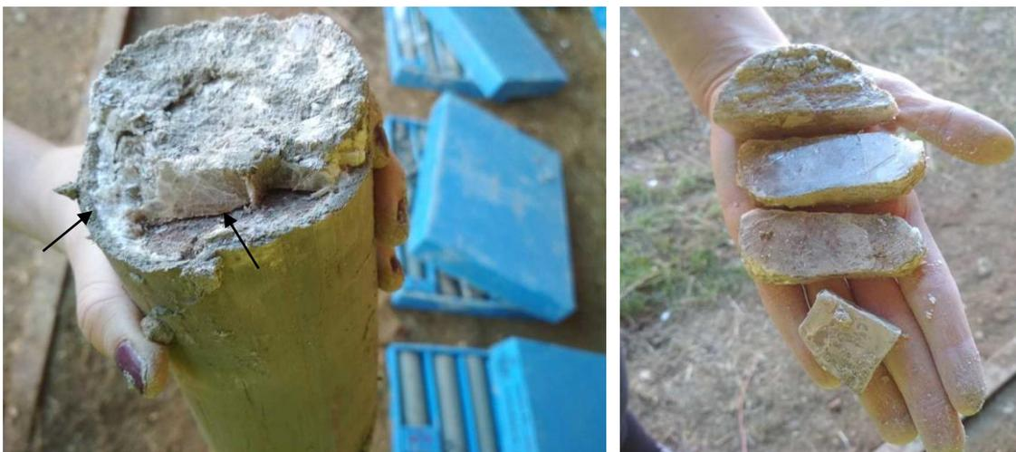
Fig. 3.26 En la imagen de la izquierda se observan cristales de yeso de alrededor de 4 cm de longitud y yeso pulverulento. A la derecha se muestra cristales de pasadas de yeso con un diámetro igual al del sondeo y espesores de 1-3 cm.
