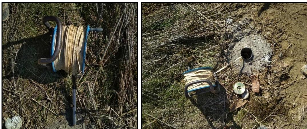
Figura 2.2 En la imagen de la izquierda se muestra una sonda de nivel. A la derecha se muestra la realización de una medición del nivel freático.
