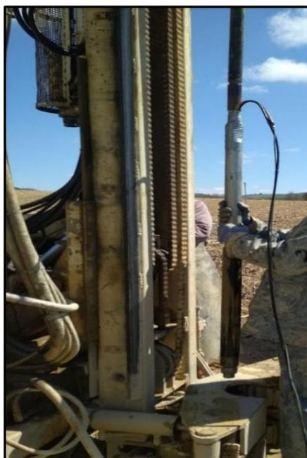
Figura 2.6 Ensayo presiométrico durante la realización de un sondeo.
