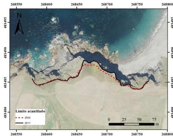
Figura 28: Comparación del límite del acantilado para el tramo E en el año 2006 y 2017
