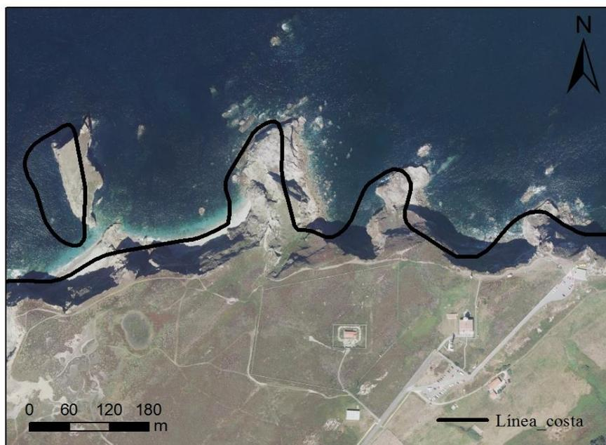
Figura 3: Ejemplo de desajuste de la línea de costa descargada del Centro de Descargas del CNIG en el Cabo Peñas.
