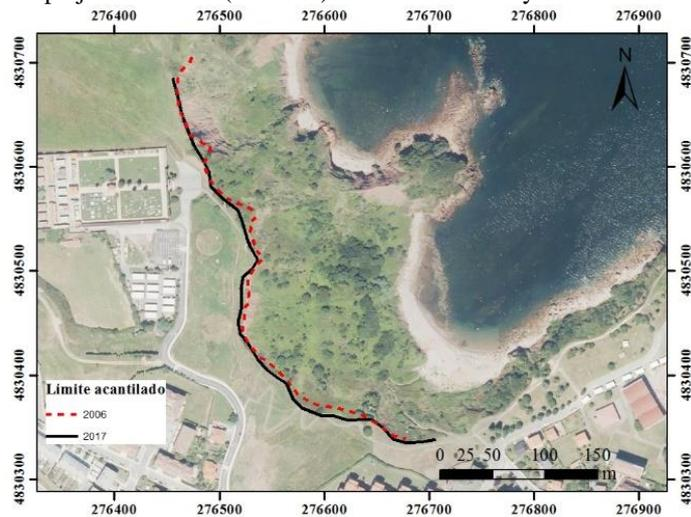
Figura 36: Comparación del límite del acantilado para el deslizamiento de Candás en el año 2006 y 2017.
