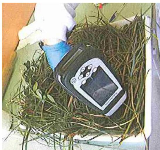
**Fig. 3.4 Medición de muestra de vegetación apetecible con equipo portátil MicroPhazir<sup>TM</sup>**
