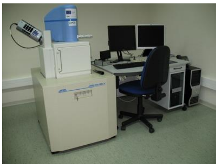
Figura 12. Microscopio electrónico de barrido JEOL-6610LV empleado en el ensayo de microscopía.
