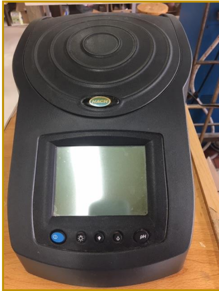
Figura 23. Espectrofotómetro Hach DR/2400 para azúcares totales (izquierda) y espectrofotómetro Analytik Jena SPEKOL 1300/1500 para azúcares reductores (derecha).
