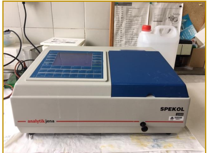
Figura 23. Espectrofotómetro Hach DR/2400 para azúcares totales (izquierda) y espectrofotómetro Analytik Jena SPEKOL 1300/1500 para azúcares reductores (derecha).
