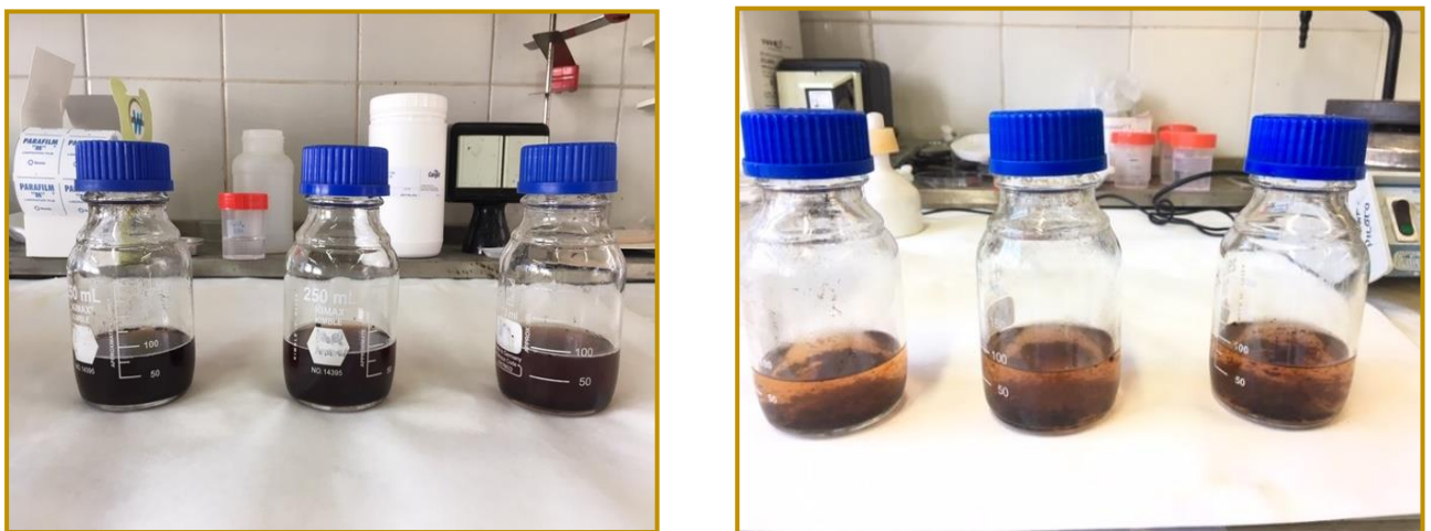
Figura 22. Muestras de cascarilla de cacao en la extracción de azúcares potenciales, antes de autoclavar (izquierda), y después (derecha).
