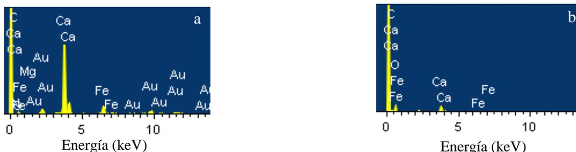
**Figura 25.** Espectro EDX de los catalizadores Fe 15% (a) y Fe 15% calcinado (b).
