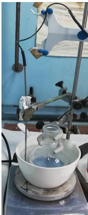
**Figura 16.** Montaje para la impregnación de los metales.
