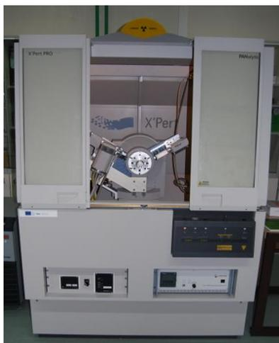
**Figura 10.** Equipo para análisis XRD (PANalyticalX'Pert Pro) (WEB 12).
