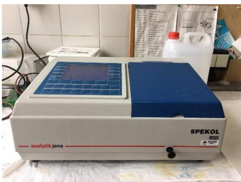
**Figura 21.** Espectrofotómetro SPEKOL 1500 (Analytik Jena).
