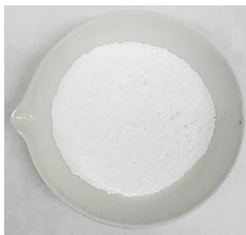
**Figura 15.** Cáscara de huevo calcinada (material de partida para la síntesis de las nanopartículas).
