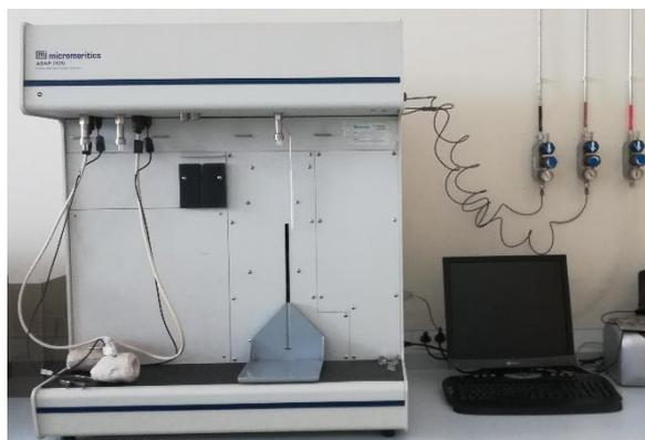
**Figura 11.** Equipo para análisis adsorción/desorción ASAP 2020 Micromeritics.
