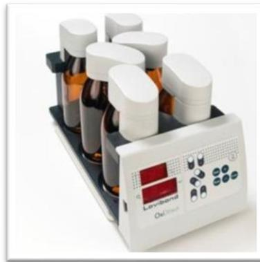
**Figura 23.** Equipo Lovibond Oxidirect para la determinación de la DBO<sub>5</sub>.
