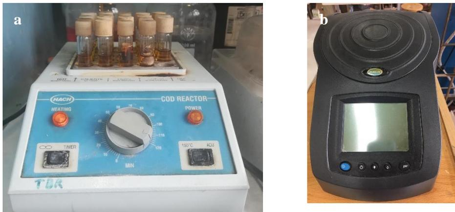
**Figura 22.** Digestor COD Reactor Hach (a) y Espectrofotómetro Hach DR/2400 (ib)
