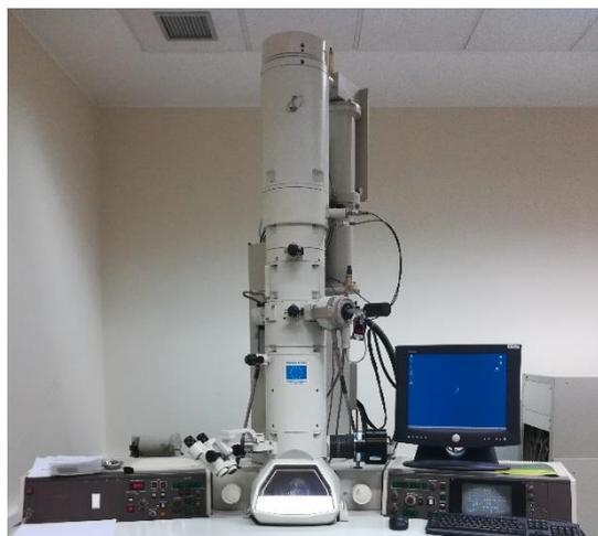
**Figura 13.** Microscopio de transmisión electrónica (JEOL-2000 EX-II).
