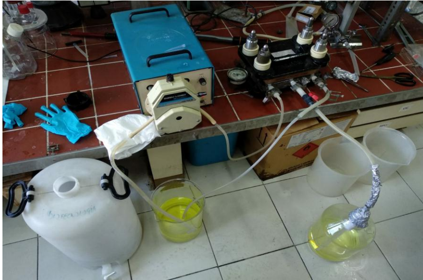
Figura 11. Equipo de microfiltración tangencial empleado.
