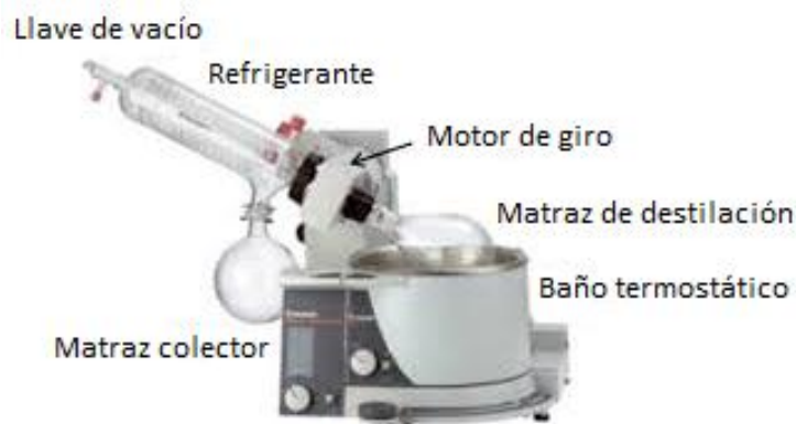
Figura 6. Componentes de un rotavapor.
