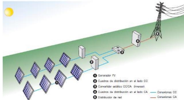
Figura 2.5.- Sistema conectado a la red[4]
