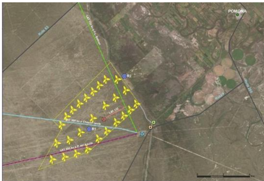
Figura 5. Distribución de los aerogeneradores en la Parcela. Fuente: Genneia. Documento interno: Resumen no técnico. 2018.
