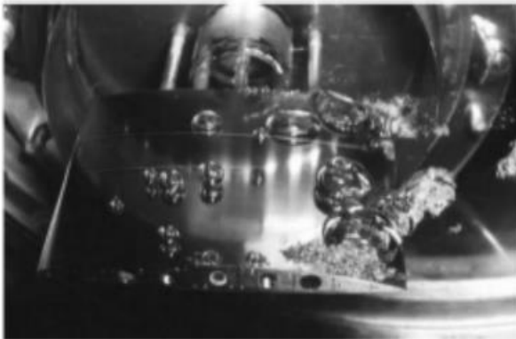
Figura 7 – Cavitación itinerante sobre la cara de succión de una pala (Binama, 2016).
