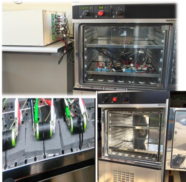
Fig. Anexo 11 Instrumento Arbin BT-2000 (arriba a la izquierda), cámara usada durante los ensayos de ciclado a largo plazo (abajo a la derecha) y baterías ensayadas conectadas al Arbin BT-2000.
