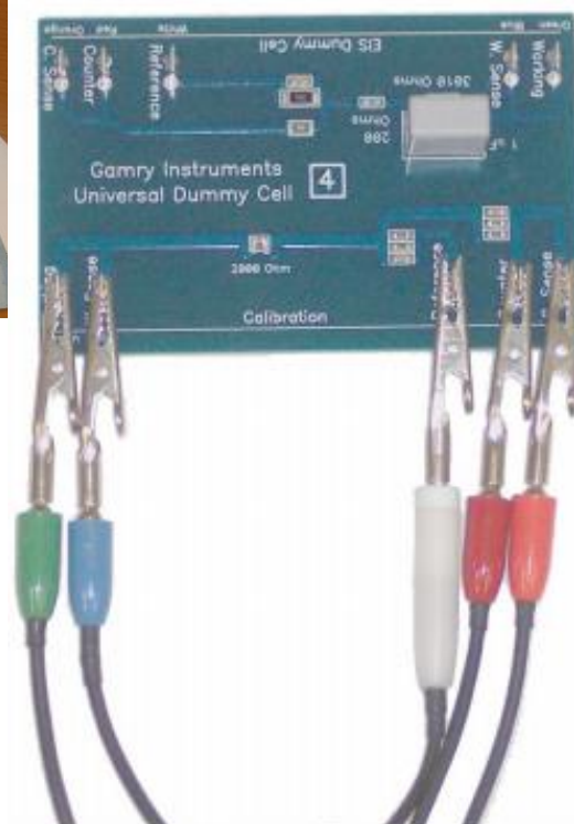
Fig. Anexo 4 Forma de conexión de Gamry Reference 3000.
