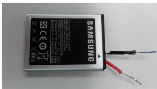
Fig. Anexo 14 Batería LCO con cables soldados en los terminales.
