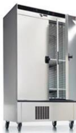
Fig. Anexo 12 Arriba una batería dentro de la jaula de Faraday conectada al equipo Gamry Reference 3000, dentro de una cámara Memmert ICP-800, abajo, la cámara Memmert ICP-800.
