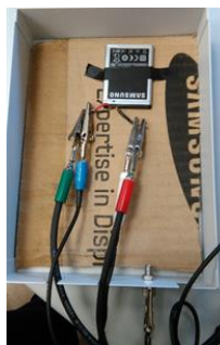
Fig. Anexo 15 Batería conectada al instrumento dentro de la jaula de Faraday.
