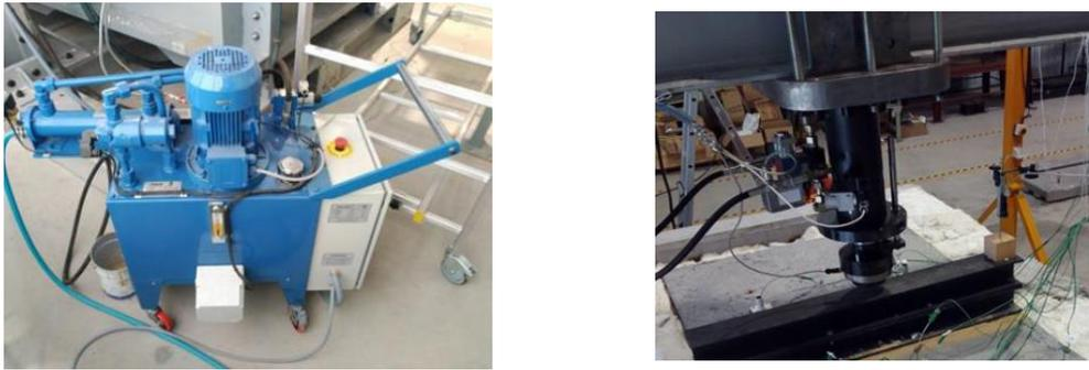
Fig 57. Equipo utilizado para la aplicación de la carga: equipo hidráulico (izquierda) y actuador (derecha).
