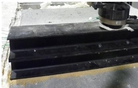
Fig 58. Viga utilizada para el reparto de la carga.
