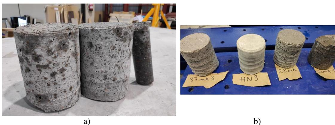
Fig 24. Muestras extraídas: a) Geometrías de diferentes tamaños. b) Muestras de mayor diámetro para cada tipo de hormigón.
