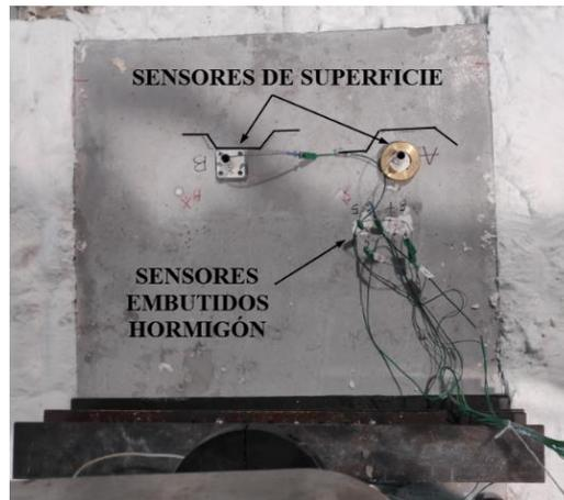
Fig 65. Vista en planta de la colocación de los termopares (cara no expuesta).
