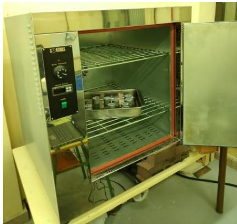
Fig 34. Horno de secado de las probetas.
