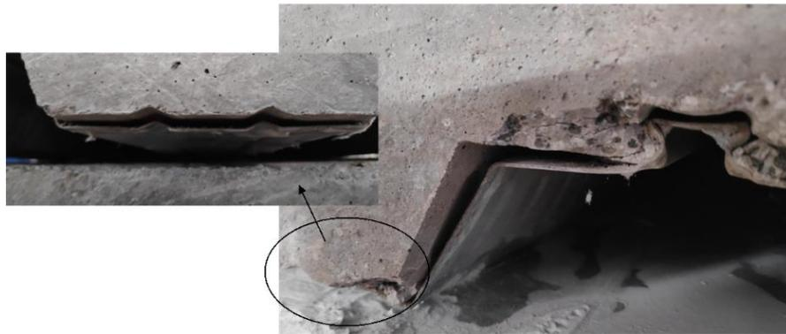
Fig 78. Despegue entre la chapa y el hormigón al finalizar los ensayos.
