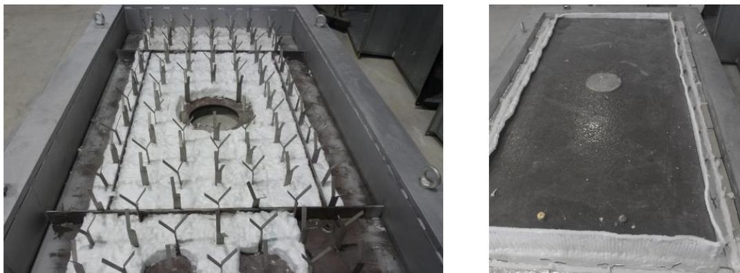
Fig 53. Construcción y composición de la tapa desmontable.
