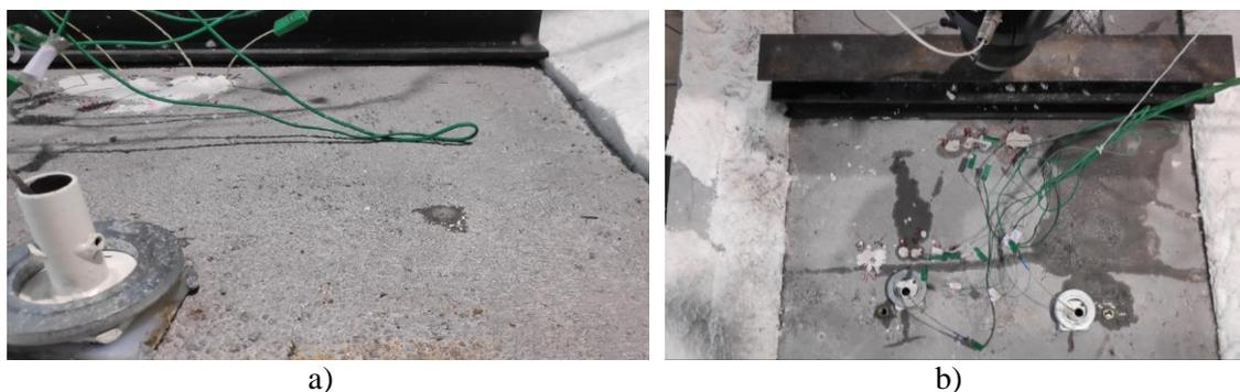
Fig 67. Agua expulsada durante el ensayo en la cara no expuesta de la losa: a) En los primeros instantes del ensayo; b) Al final del ensayo.
