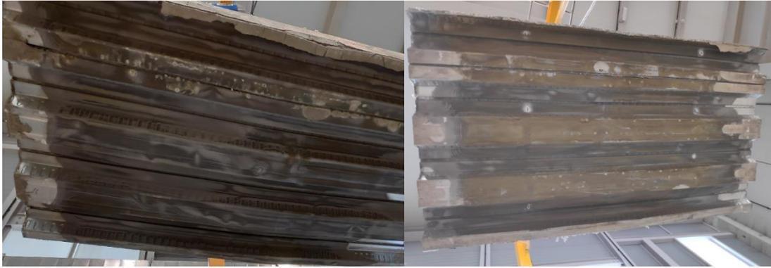
Fig 68. Integridad de la chapa de acero al finalizar el ensayo.
