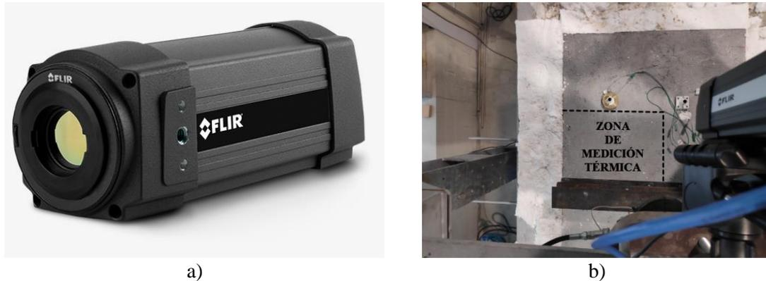
Fig 62. Cámara termográfica: a) Cámara termográfica FLIR ([123]); b) Colocación en el ensayo.
