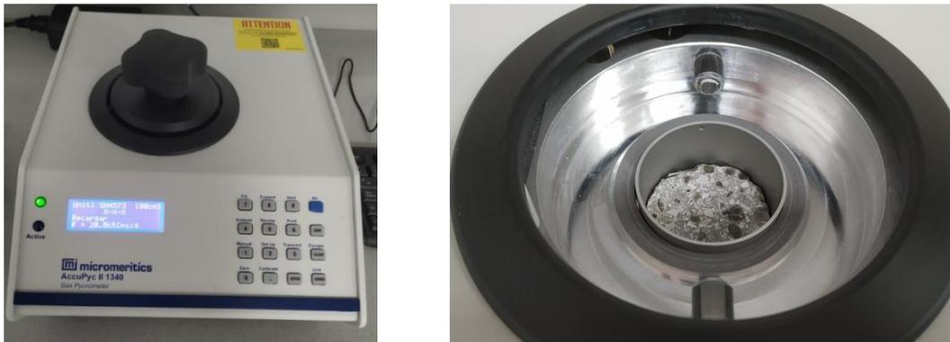
Fig 18. Equipo para la medición de la densidad real: a) Picnómetro; b) Muestra de HL en el portamuestras del picnómetro.
