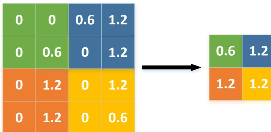
Figura 3.14.- Ejemplo de Max-Pooling
