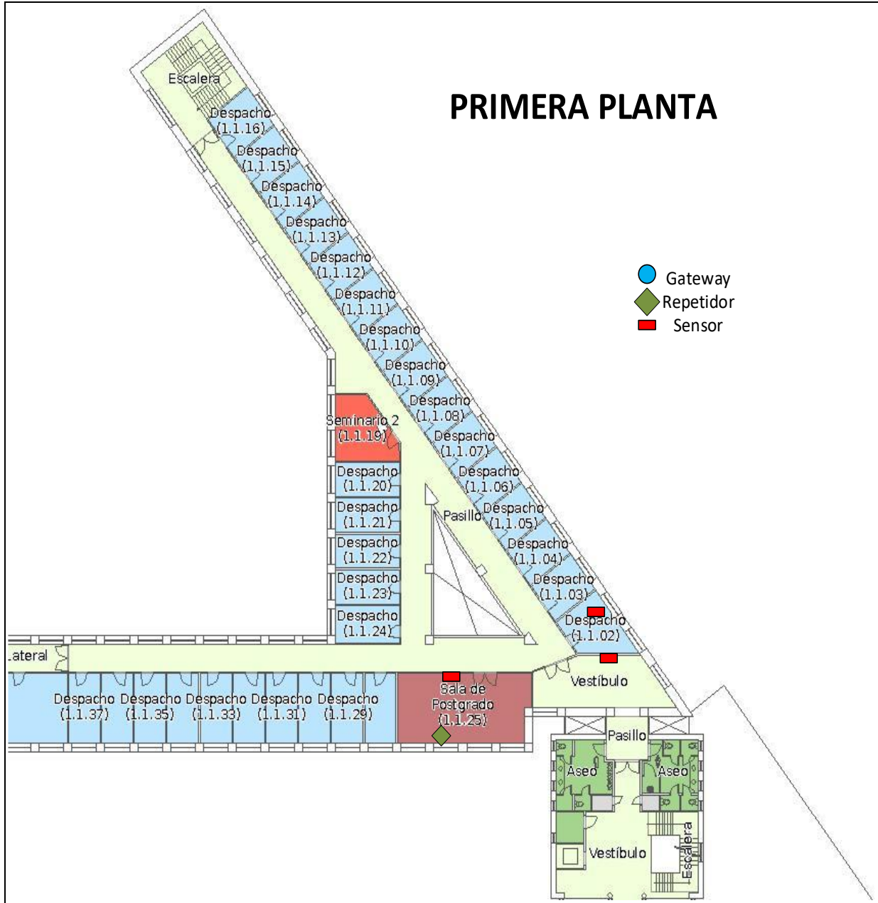
Ilustración 49: Distribución de los módulos multisensor (Planta 1)
