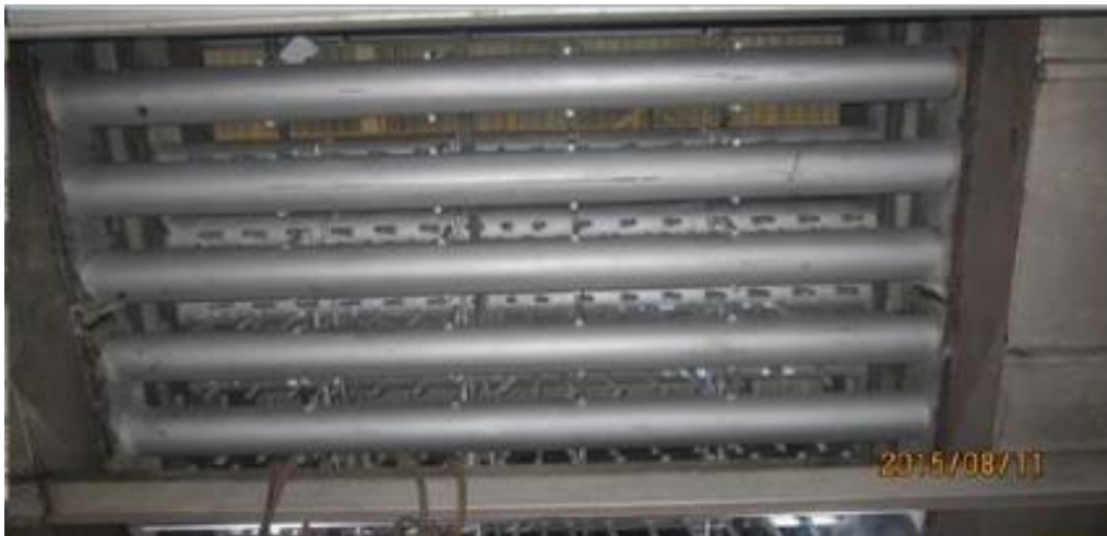
Figura 9 Sistema Blowstab de enfriamiento ultrarrápido de CMI Industry
