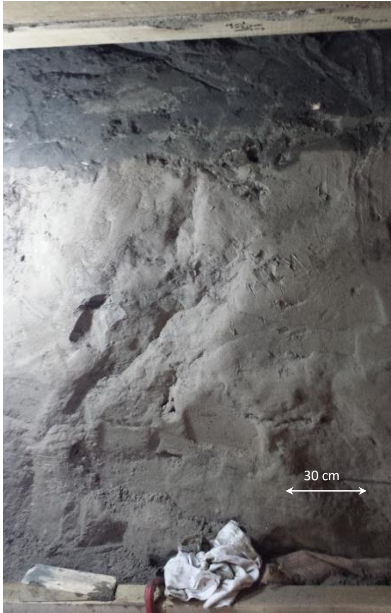
Figura 13.- Aspecto de los niveles superiores de las Arenas Thanet en una excavación que previamente ha sido drenada. En la parte superior se observa el contacto con la Formación Upnor del Grupo Lambeth. Fuente: Autor.
