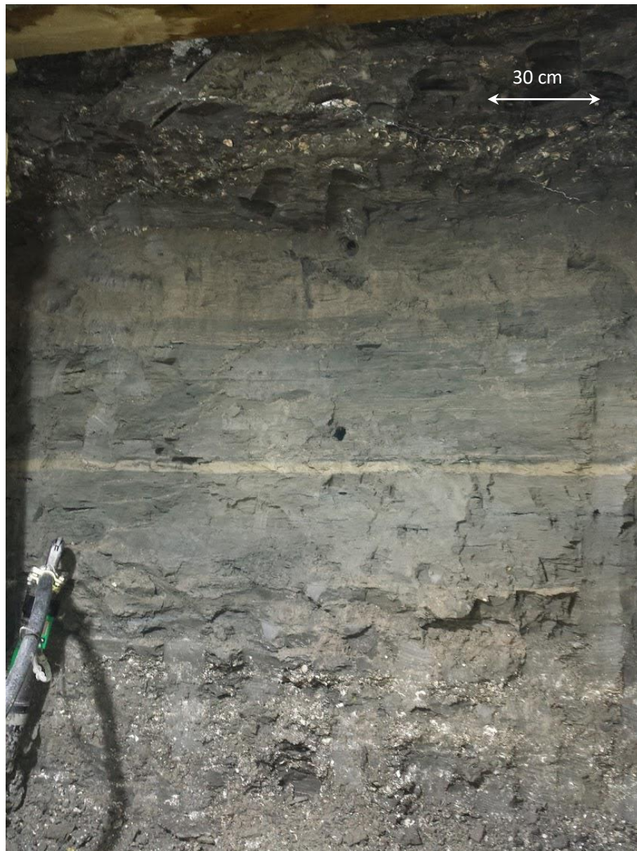
Figura 17.- Aspecto de la Formación Woolwich en un frente de excavación manual. En la parte superior se observa el contacto de las Arcillas Conchíferas Superiores sobre las Capas Laminadas. Fuente: Autor.
