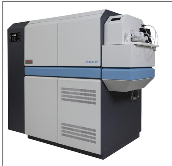
Fig. 22. Imagen del HR-ICP-MS modelo ELEMENT2 utilizado para los análisis del estudio.
