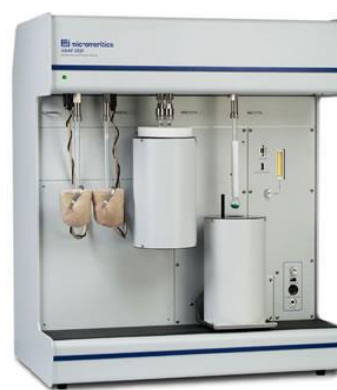
Figura 3.2 ASAP 2020 de Micromeritics para fisisorción.
