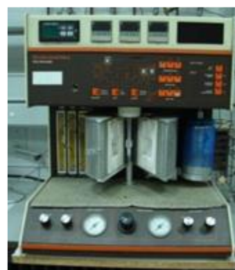
Figura 3.3 Micromeritics TPD/TPR 2900 utilizado para análisis TP.
