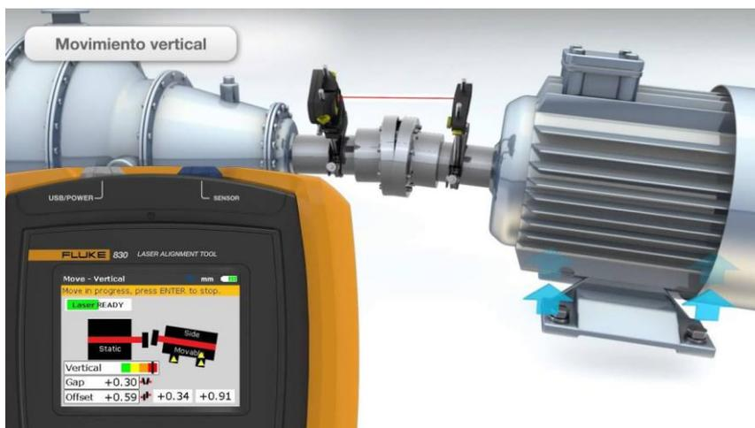
Ilustración 28. Equipo portátil de alineación láser. Fuente: Fluke.
