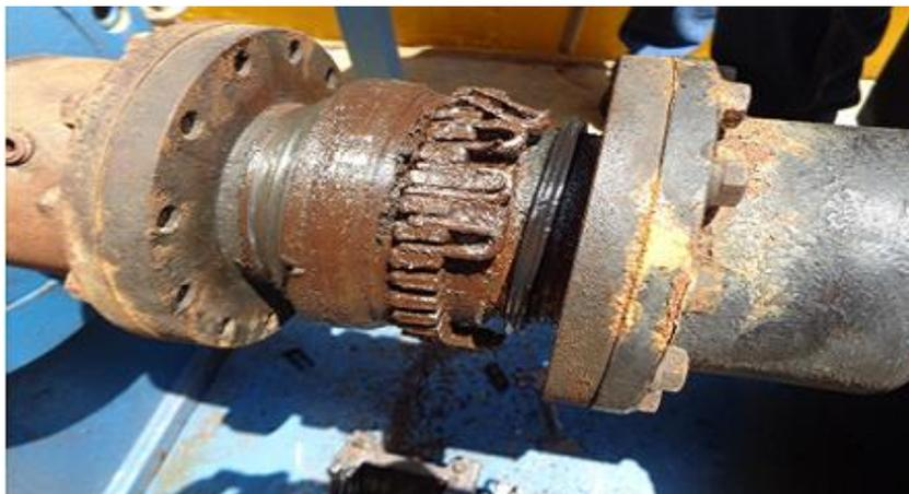
*Ilustración 19. Acoplamiento de bomba centrífuga con avería por falta de lubricación.*
