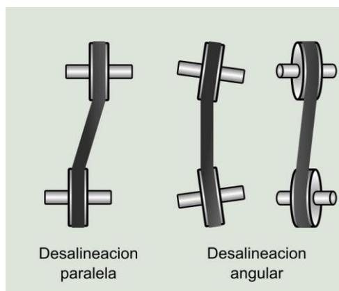
*Ilustración 30. Desalineación en poleas. Fuente: Power-MI.*
