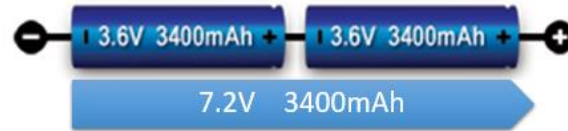
Figura 43: Conexión de dos celdas en serie. Fuente [12].
