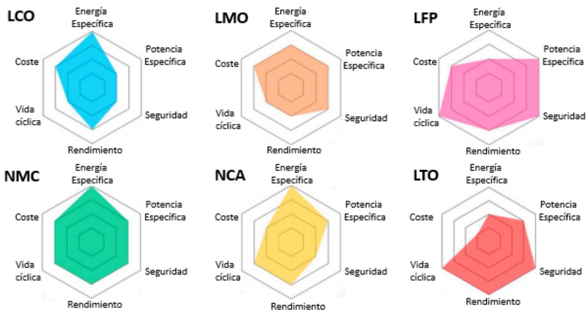
Figura 7: Comparación entre las principales tecnologías de baterías de litio-ion existentes en el mercado. Fuente [15].
