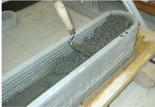
Figura 2. Encofrado con hormigón convencional [10].
