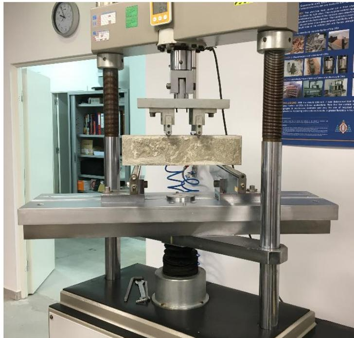
Figura 17. Ensayo flexotracción. Acción carga.
