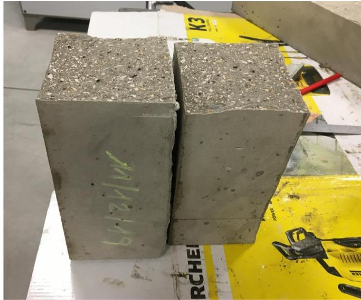
Figura 19. Ensayo flexotracción. Inspección visual rotura.
