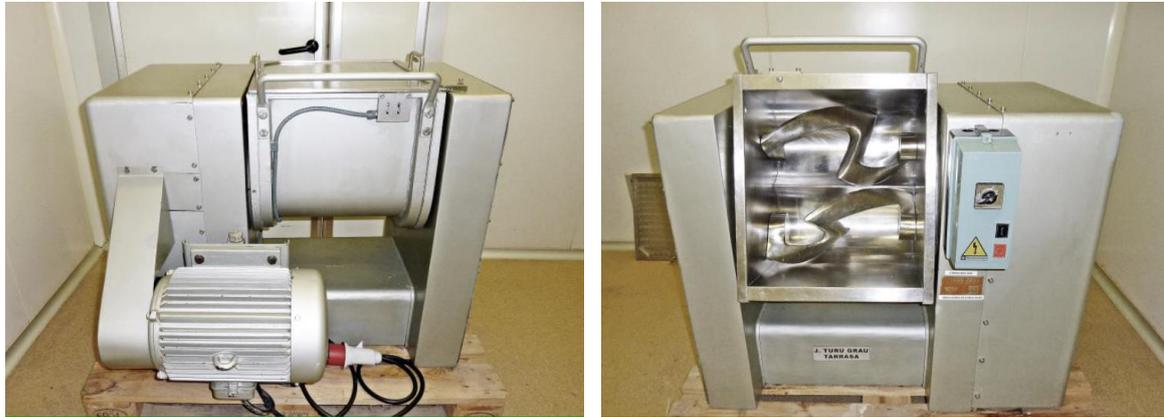
Figura 9. Amasadora de tipo doble sigma.
