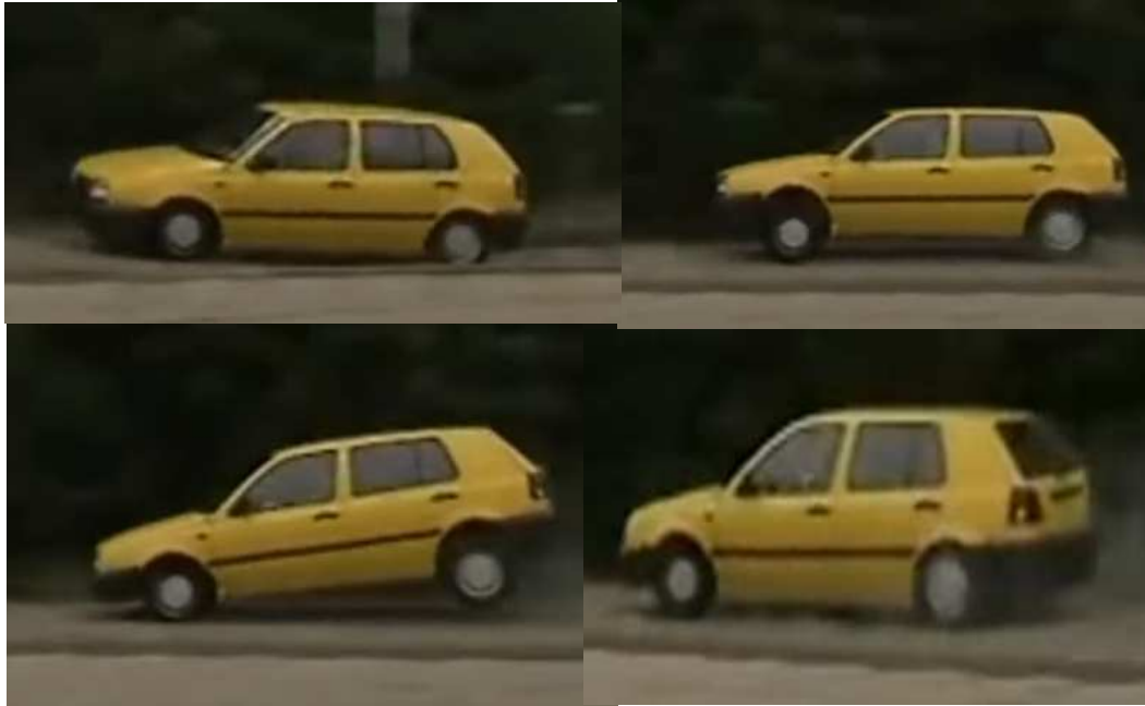
Figura 12 Prueba sobre firme muy ondulado
