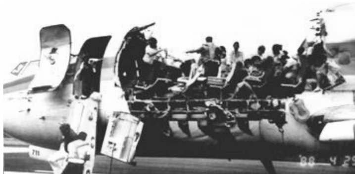
Figura 1 Accidente por fallo estructural en el fuselaje de un avión
