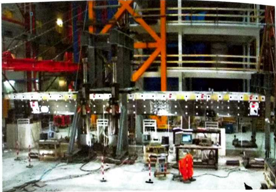
Figura 24 Ensayo en laboratorio de viga polimérica para puente
