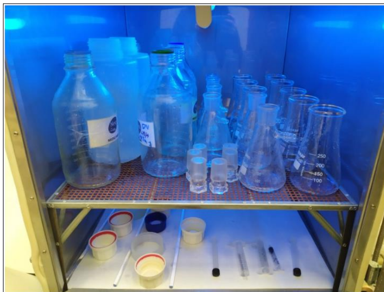
Figura 22. Desinfección del material mediante aplicación de luz ultravioleta (UV).
