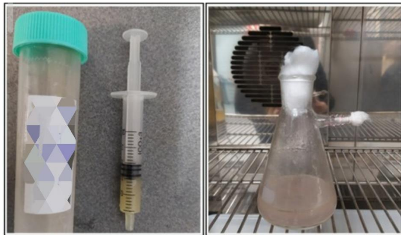
Figura 23. Proceso de incubación de las bacterias SRB. Tras la preparación y desoxigenación del medio adecuado para su crecimiento.
