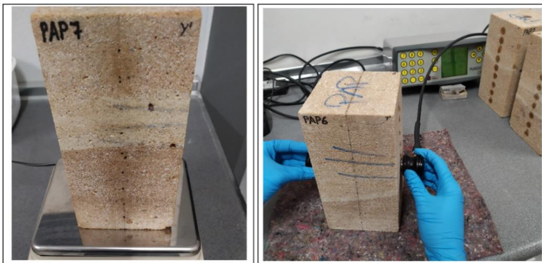
Figura 7. Determinación de la velocidad de propagación de ondas P por transmisión directa en las probetas de arenisca de Postaer. A la izquierda se pueden ver las marcas correspondientes a los puntos donde se hicieron las medidas. A la derecha, realización del ensayo.
