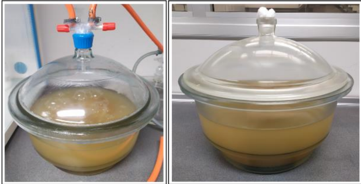
Figura 26. Desalinización de la probeta PAP7 mediante vacío y bacterias nitrato reductoras (NRB). A la izquierda, durante la aplicación del vacío tras introducir el medio de cultivo en la campana (duración de 24 horas). A la derecha, la muestra sumergida durante el periodo de reposo de siete días.
