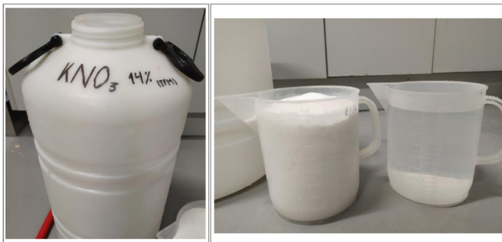
Figura 17. Proceso de preparación de la salmuera, en este caso con la sal \text{KNO}_3 a una concentración del 14 %.
