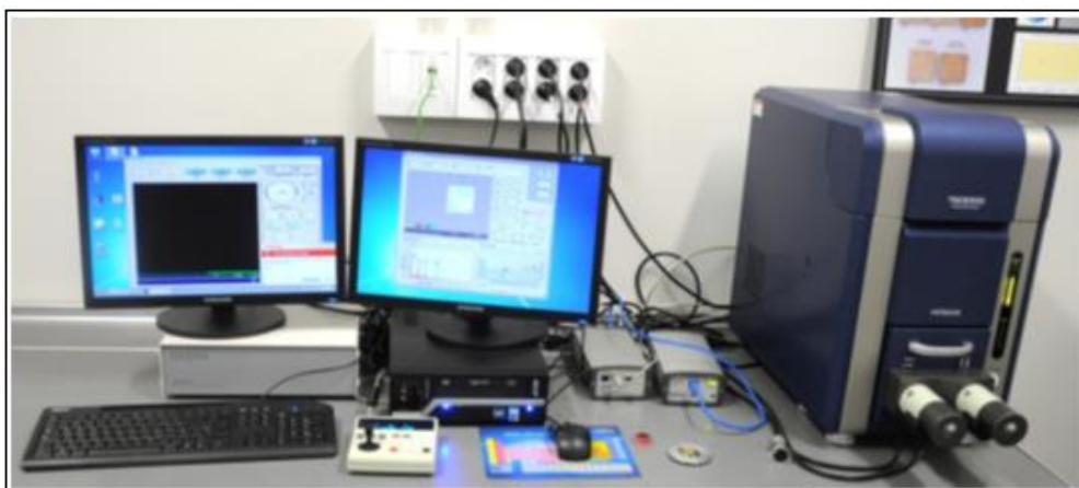
Figura 8. Detalle del microscopio electrónico de barrido (MEB) con microanalizador incorporado (EDX) utilizado en el presente trabajo.
