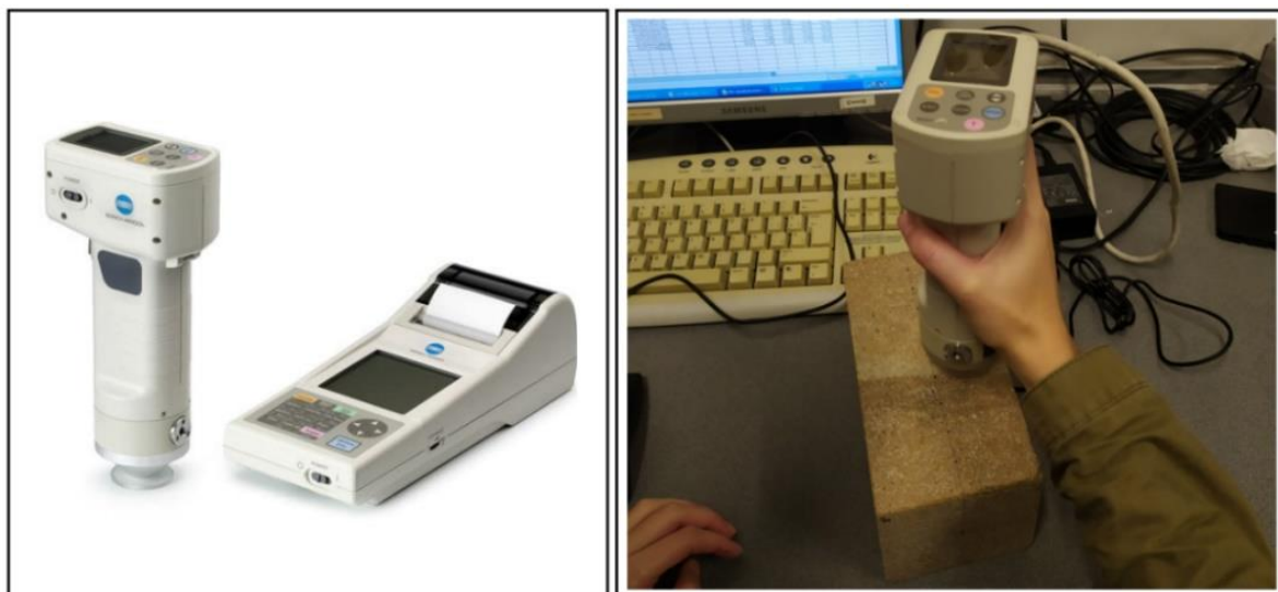
Figura 10. Detalle del colorímetro tri-estímulo modelo CR-400/410 (KONICA). A la izquierda, equipo para utilizar de forma portátil. A la derecha, el mismo colorímetro utilizado de forma que los datos se transmitan directamente al ordenador mediante un software especializado.
