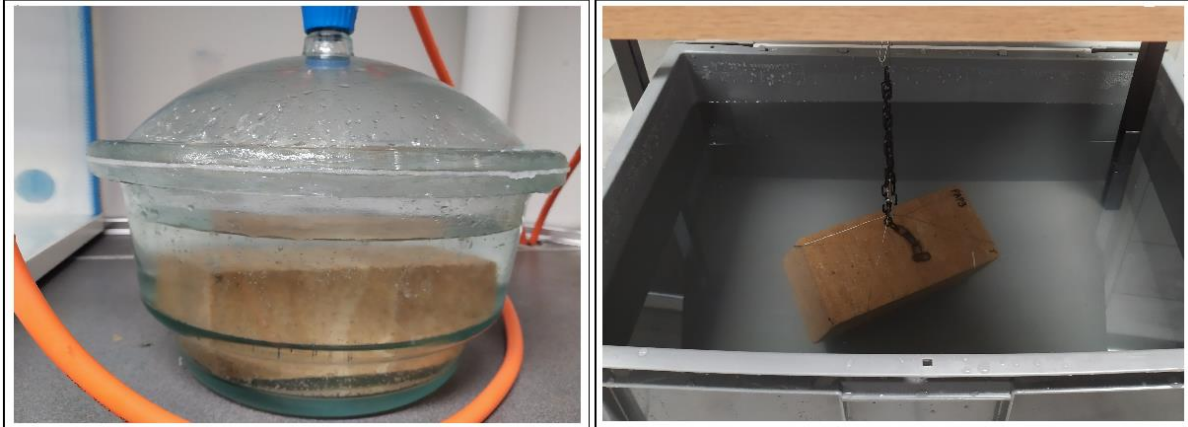
Figura 12. Ensayo de absorción forzada mediante vacío. A la izquierda, la campana donde se hacen los vacíos. A la derecha, la pesada hidrostática posterior.
