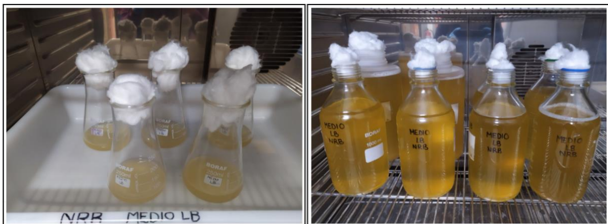
Figura 24. Preparación del medio para las bacterias nitrato-reductoras. Izquierda, incubación previa. Derecha, resultado. Ambos en estufa de ventilación forzada a 30°C.
