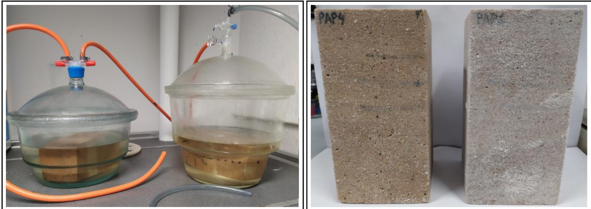
Figura 18. A la izquierda, proceso de salinización mediante vacío de las muestras PAP7 (izq) y PAP8 (drch). A la derecha, la probeta PAP 4 salinizada con \text{NaSO}_4 tras 9 días en la estufa y la probeta PAP6 salinizada con \text{KNO}_3 tras 3 días en la estufa.
