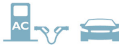
Figura. 27 Modo de carga 3 tal y como se describe en la norma IEC 61851-1. Fuente: [19]
