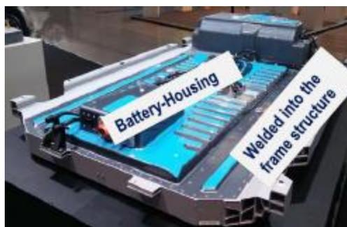
Figura 34. Ejemplo de arquitectura integrada de un paquete de baterías[123].
