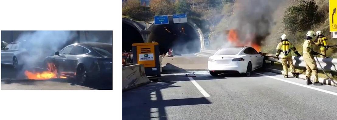
*Figura 24. Ejemplos de los peligros del embalamiento térmico en vehículos eléctricos[114].*
