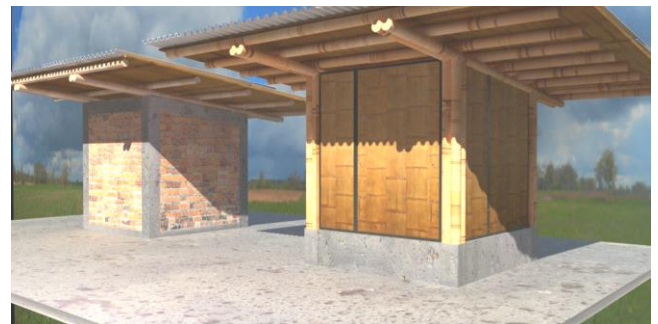
Figura 1. Diseño arquitectónico del módulo de cemento y ladrillo convencional (izquierda) y del módulo fabricado con bambú Guadua (derecha)
