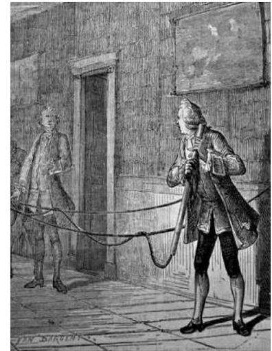
Gray consigue transmitir la electricidad a través de un hilo metálico de 200 m de longitud.
