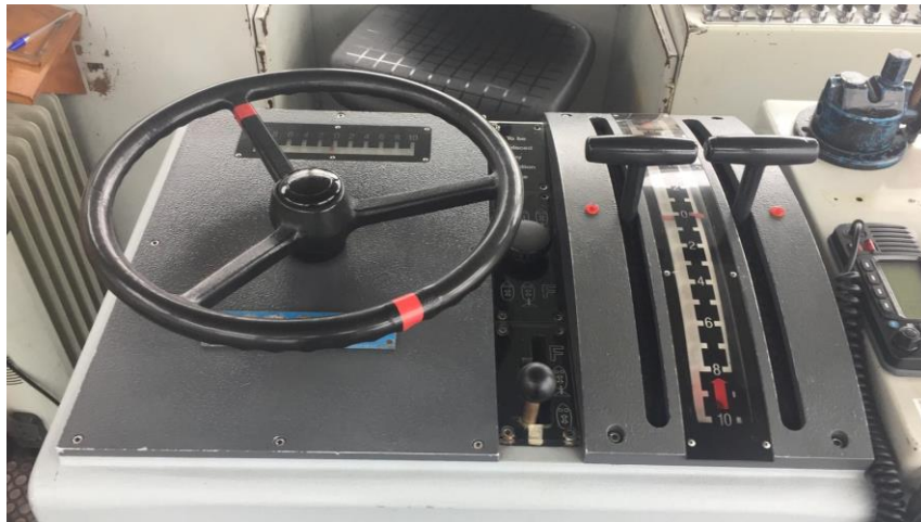
Ilustración 33: Volante y palancas del "Sertosa veintiocho" (Autoría propia)
