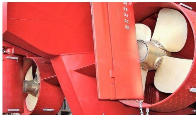
Ilustración 24: Tobera tipo Kort ( www.cx9aaw.wordpress.com )
