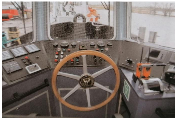
Ilustración 28: Aparatos de gobierno de un remolcador convencional (The tug book, J.M. Gastón)
