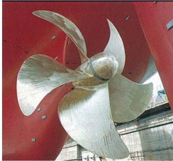
Ilustración 22: Hélice de paso fijo ( www.marineinsight.com )
