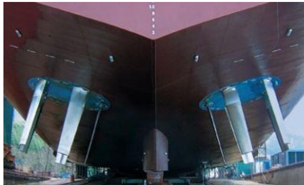
Ilustración 30: Propulsión VSP ( www.ingmaritima.blogspot.com )
