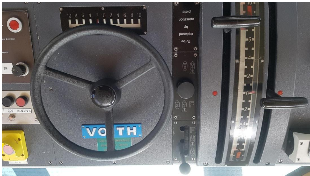
Ilustración 41: Palancas y volante de remolcador Voith (Autoría propia)
