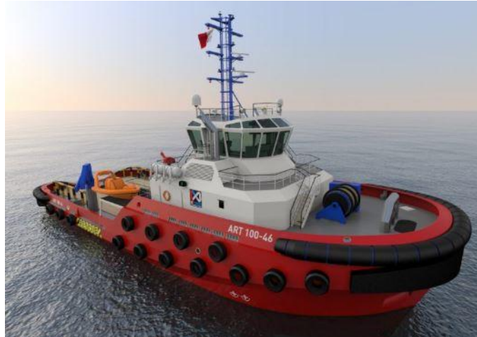
Ilustración 8: Defensas del remolcador ( www.sectormarítimo.es )
