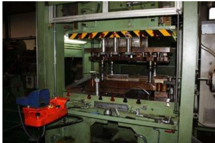
Figura 16. Troquel en el proceso de estampación
