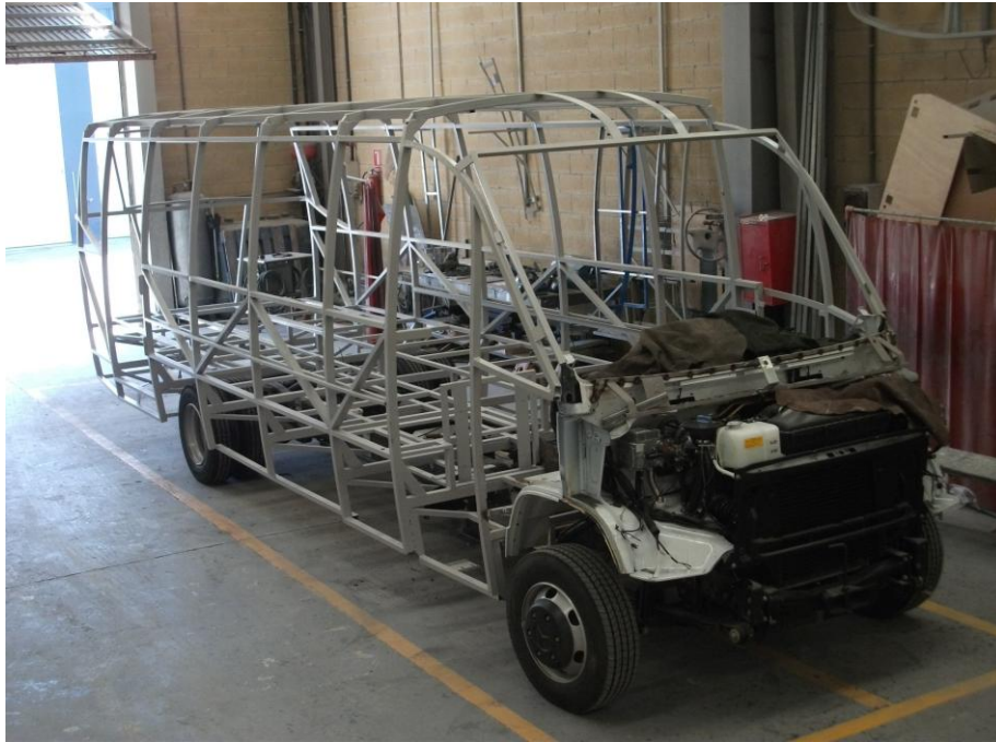
Figura 22. Estructura metálica montada en el bastidor en la primera fase del proceso productivo.
