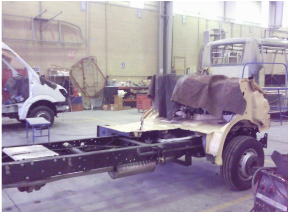
Figura 21. Estructuras metálicas obtenidas en la primera fase del proceso productivo.
