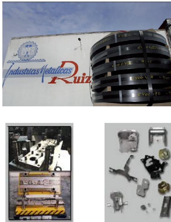
Figura 17. Bobina de chapa utilizada en el comienzo del proceso productivo, instantánea del proceso productivo y productos terminados.
