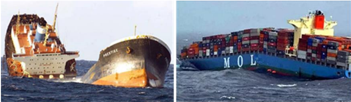
Fig. 3 Fallos estructurales en buques. Izq: Buque petrolero Prestige. Dcha: Buque portacontenedores MOL Confort.
