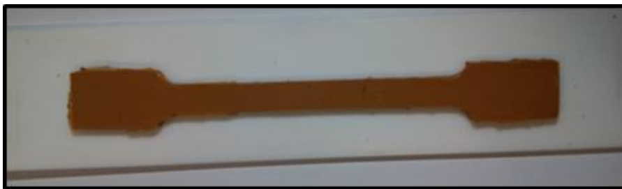
Fig. 45 Forma del composite para medidas en máquina de tracción
