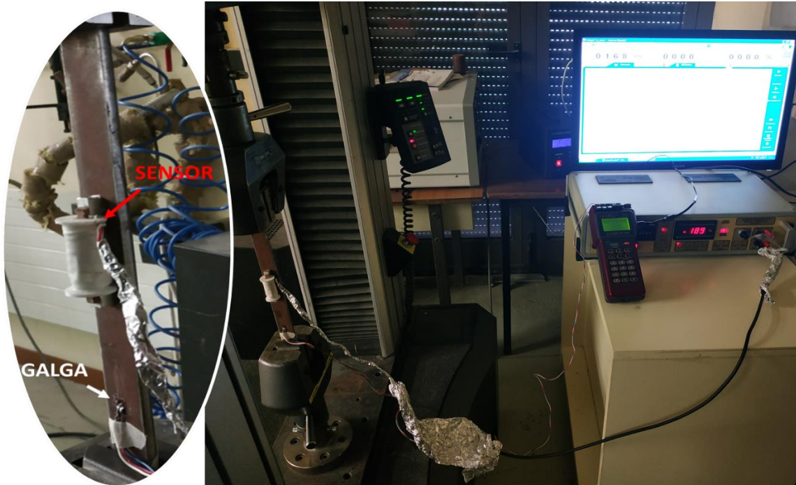
Fig. 79 Sensor y galga extensiométrica sobre probeta de acero
