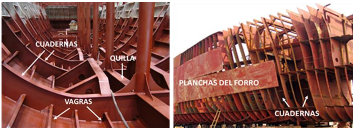
Fig. 1 Elementos estructurales longitudinales y transversales del buque
