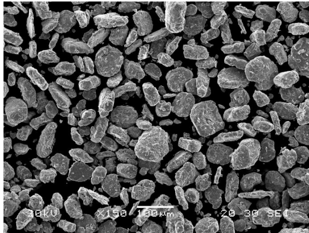
Fig. 53 Imagen SEM de las partículas de Fe 75 Ga 25
