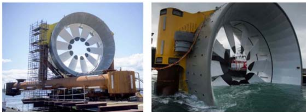
Fig.32 Turbina DCNS/OpenHydro 500 kW en Paimpol Bréhat, en el norte de Francia (Allsop et al., 2017)
