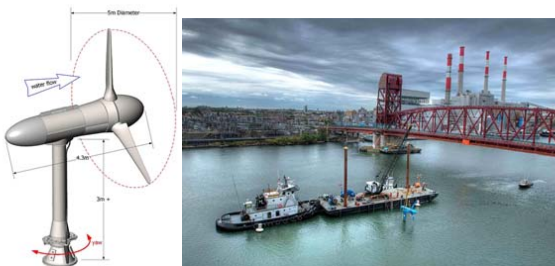
Fig.19 Infografía e instalación de la turbina de Verdant Power (V. Power, 2018)
