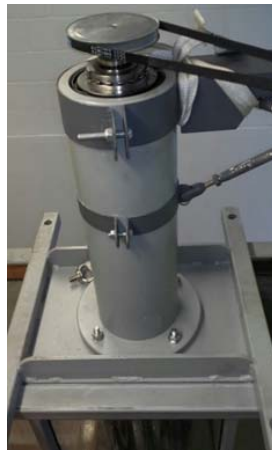
Fig.100 Estructura de soporte de las microturbinas
