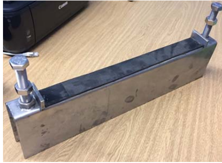
Fig.99 Pieza de apoyo entre canal hidrodinámico y tanque de aspiración
