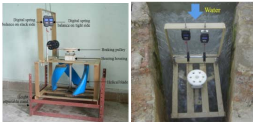
Fig.80 Turbina de ensayo e instalada en canal (Talukdar et al., 2018)
