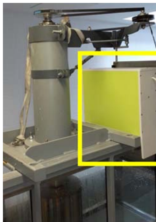
Fig.101 Disposición del limnómetro digital en el canal
