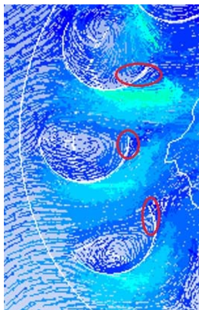
Fig.188 Zonas de álabe afectadas por desprendimientos
