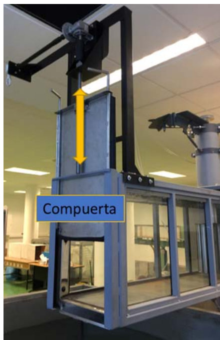
Fig.96 Fotografía de la compuerta tajadera de control
