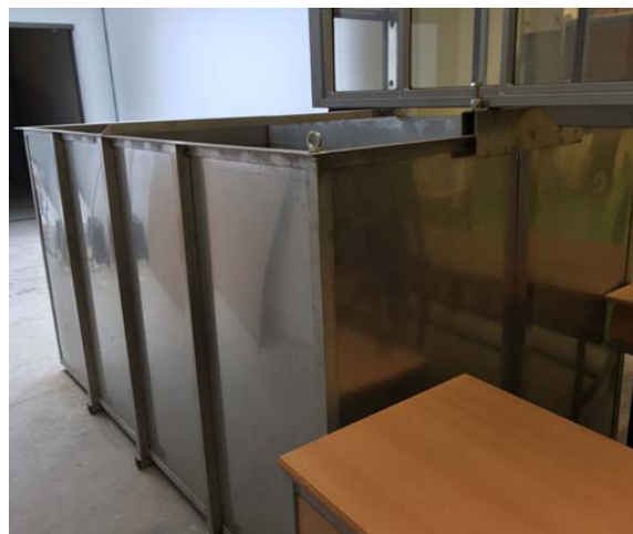
Fig.92 Fotografía del tanque de aspiración
