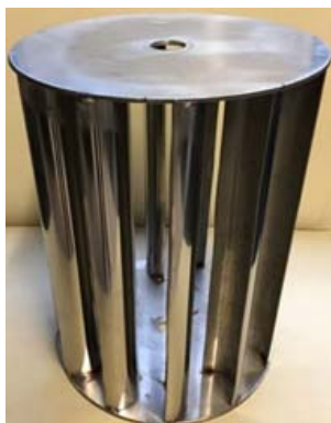
Fig.108 Fotografía del rotor construido
