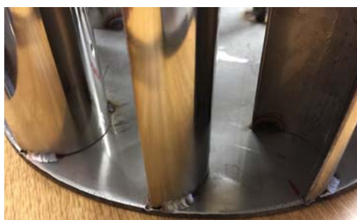
Fig.109 Detalle de la soldadura SMAW
