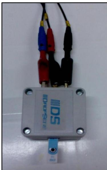
**Figura 2.3.** Conector para electrodos
