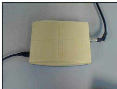
*Figura 2.1.  $\mu$ STAT 400 Bipotenciostato (Dropsens)*
