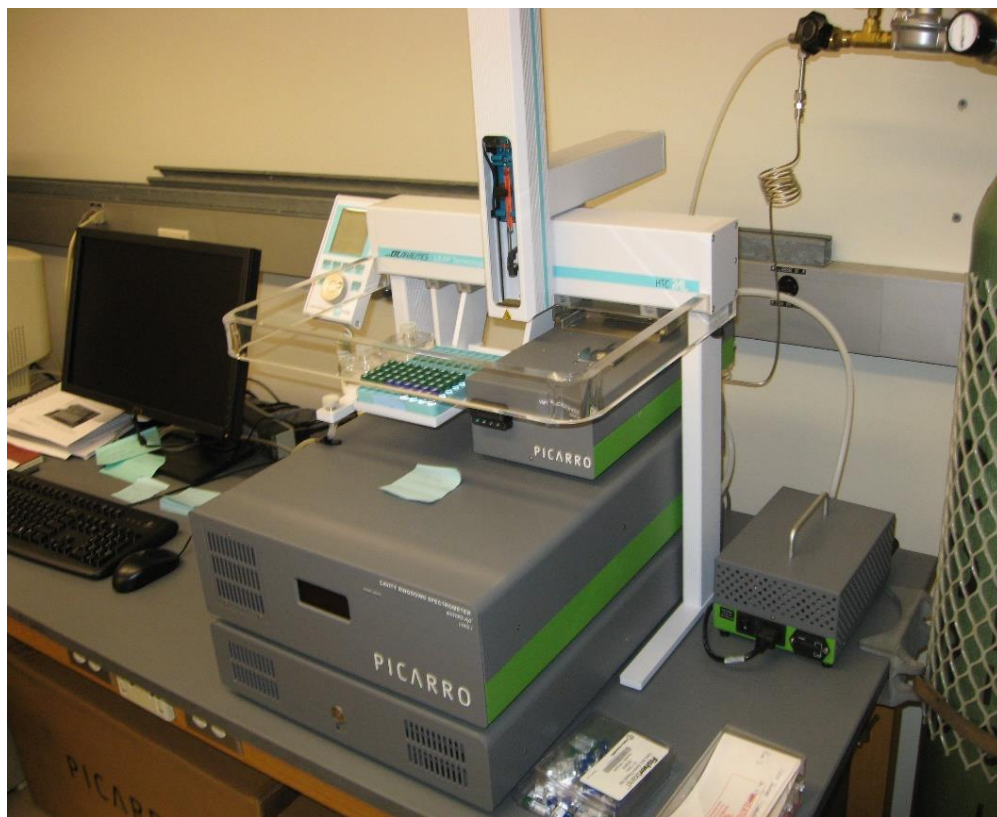
Figura 3.16. Espectrómetro de Absorción CDRS para análisis de isótopos en \text{H}_2\text{O} líquido de la marca Picarro modelo L2120-i utilizado para la medida del \delta^{18}\text{O} y el \delta\text{D} en las muestras de lluvias, en los laboratorios del departamento de biogeociencias de la Universidad Politécnica de Zürich (ETH).
