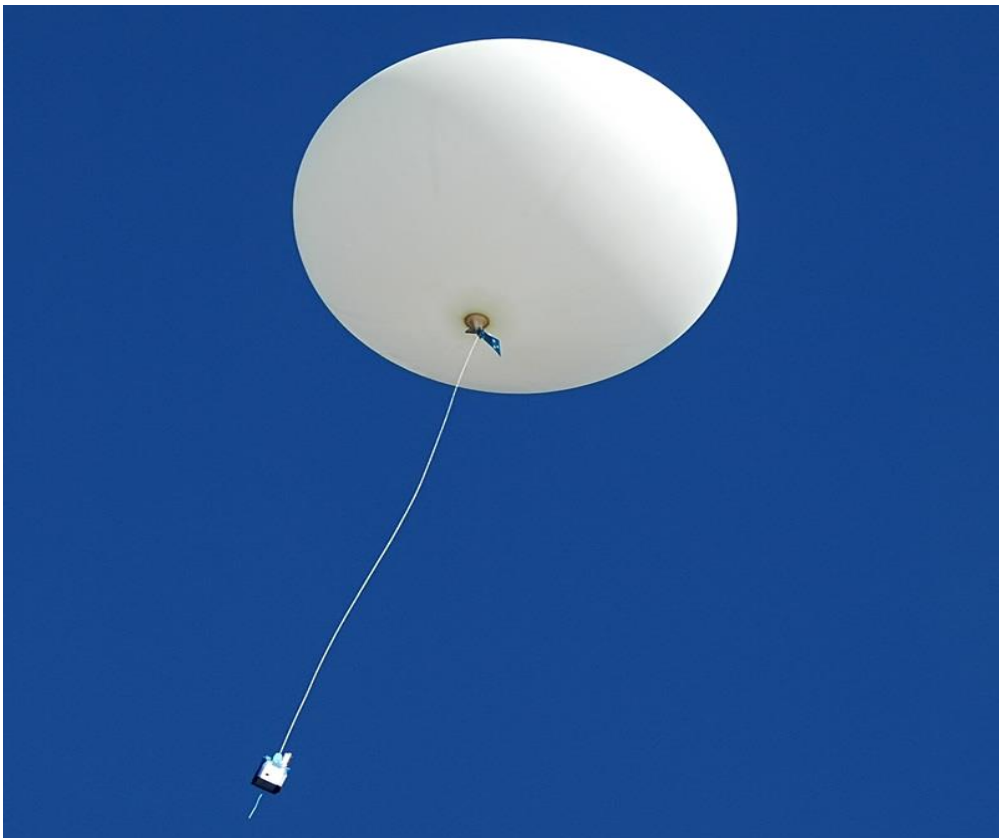
Figura 3.7. Ejemplo de estación meteorológica de monitorización de las condiciones verticales de la atmósfera, conectada a un globo sonda meteorológico relleno de He liberado en el aeropuerto de Dallas (EEUU).
