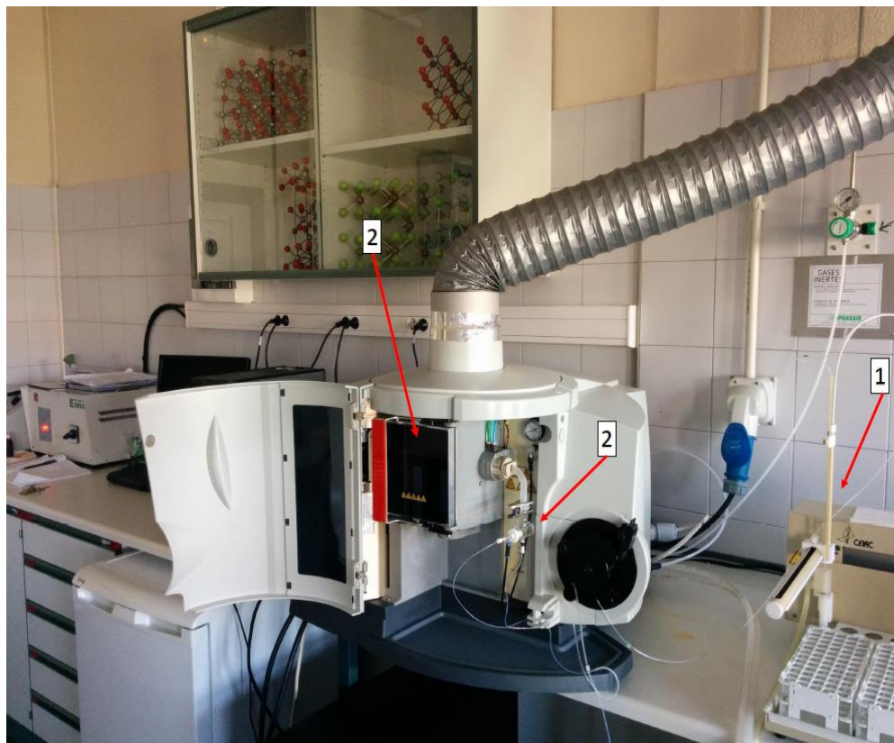
Figura 3.12. Equipo ICP-OES modelo Termo ICAP-DUO 6300 del departamento de Geología de la Universidad de Oviedo utilizado para las medidas de elementos traza por espectrometría de emisión atómica. 1) Autosampler, conectado por un conducto al 2) nebulizador de microflujo que introduce la muestra a la 3) antorcha donde se genera el plasma.
