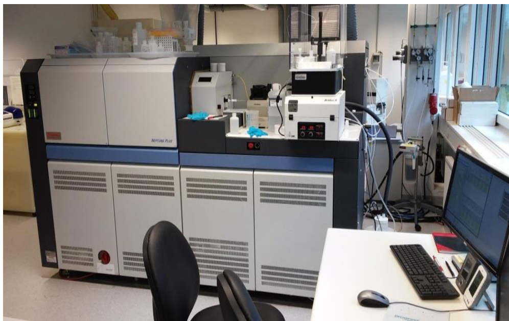
Figura 3.18. Espectrómetro de masas multicolector con plasma acoplado por inducción de la marca (ICP-MS-MC) ThermoFisher modelo Neptune, perteneciente a los Laboratorios de isótopos de la Universidad de Minnesota.
