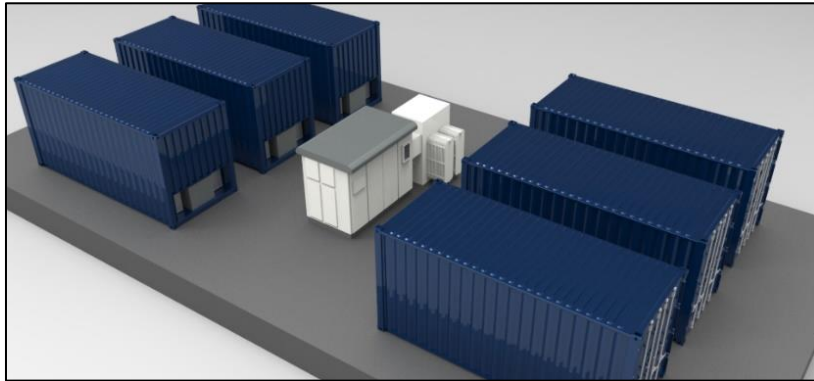
Figura 7.9.-Contenedores BESS con inversor aislado (arriba) e incorporado (abajo)
