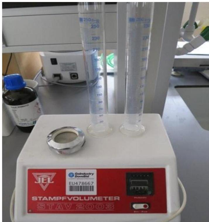
Figura 2. Instrumental para la medida del volumen.
