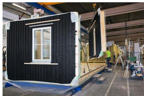
Figura 127. Módulo en cadena de fabricación
