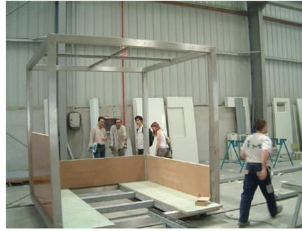
Figura 148. Módulo 3D en fabricación
