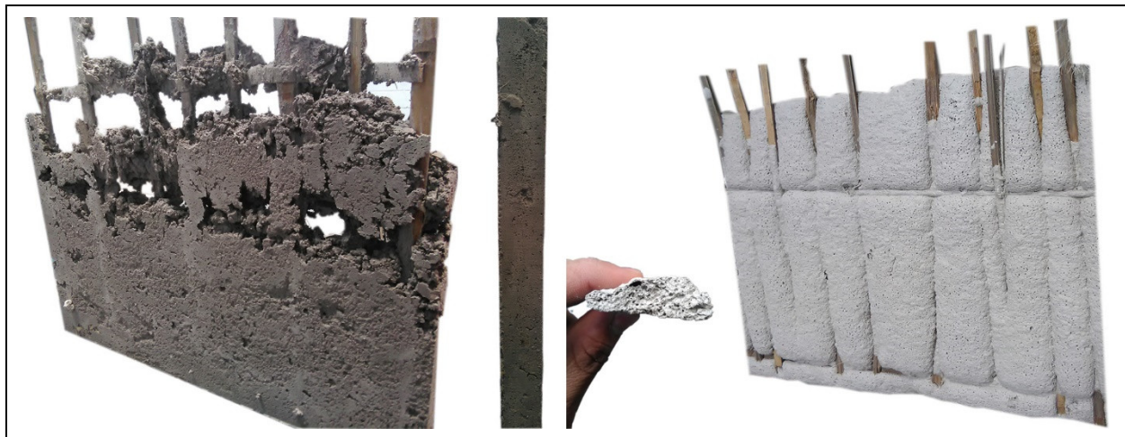
Figura 9.7. Pruebas de fabricación de páneces constructivos con malla de guadua y cemento expansivo.
