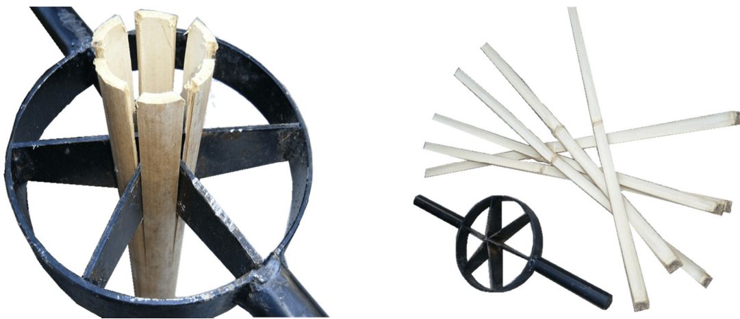
Figura 7.4. Anillo de cuchillos para lateado de Guadua. Fuente: http://mes-bambous-bis.blogspot.com/p/cette-outils-permet-de-fendre-une-canne.html
