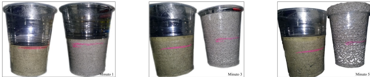
Figura 9.6. Pruebas con cemento expansivo.
