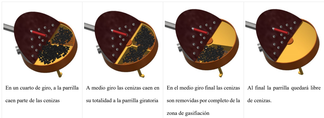
Figura 7.8. Secuencia del movimiento de la parrilla giratoria, removiendo las cenizas.
