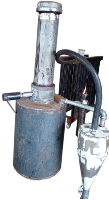
Figura 6.6. Prueba fallida, reactor con depósito grande para cenizas. Prototipo no funcional.
