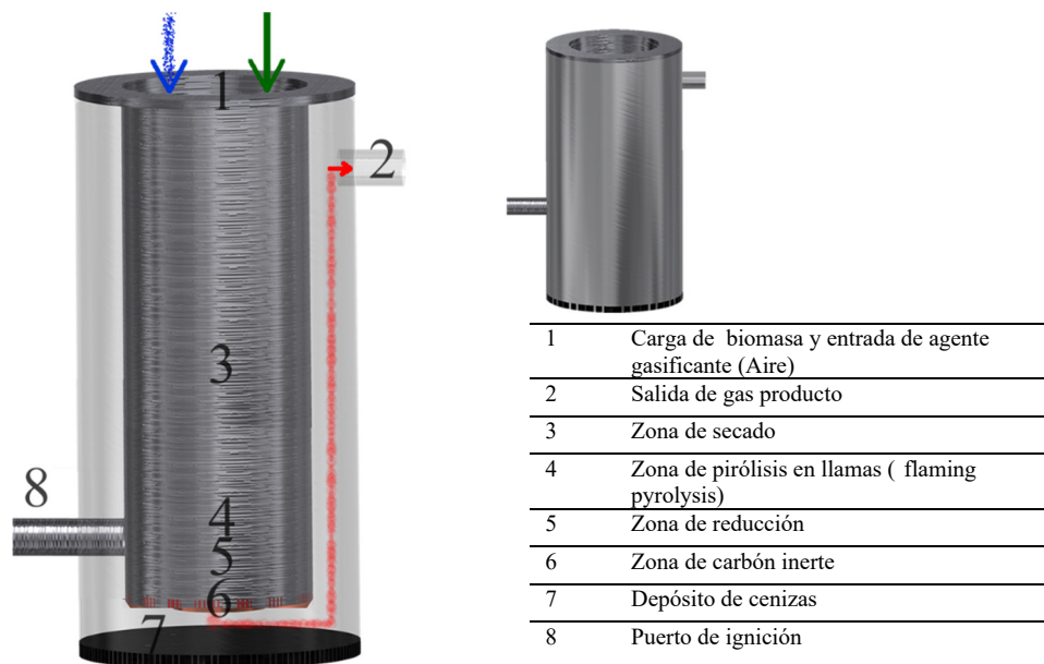
Figura 6.2. Modelo básico de gasificador en corriente descendente tapa abierta. Abajo, vista interior del gasificador con sus partes y arriba, vista orientativa del exterior del gasificador.
