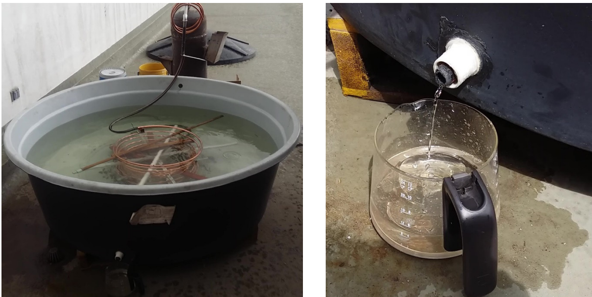
Figura 9.5. Serpentina de enfriamiento y caudal de condensado
