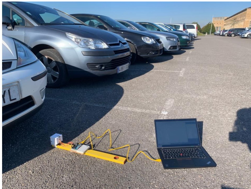
Figura 4.51.- Colocación del sensor para obtención del umbral.
